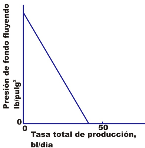
Figura 5. IPR que muestra que la formación es incapaz de producir la tasa deseada.
