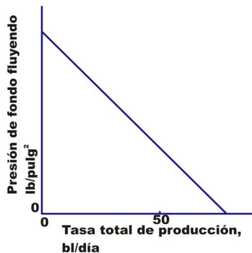
Figura 6. IPR que muestra que la formación es capaz de producir la tasa deseada.
