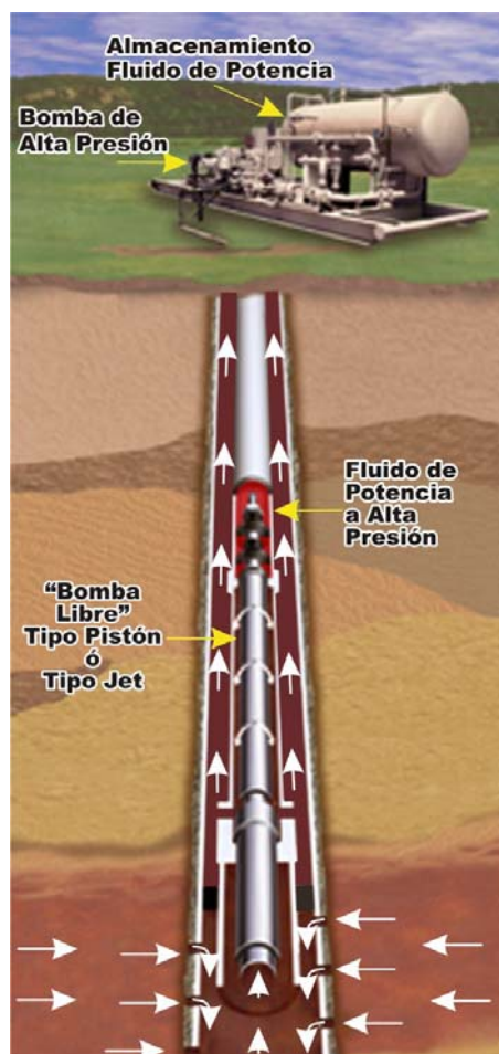
Figura 29. Esquema típico bombeo hidráulico tipo Pistón o Jet.
