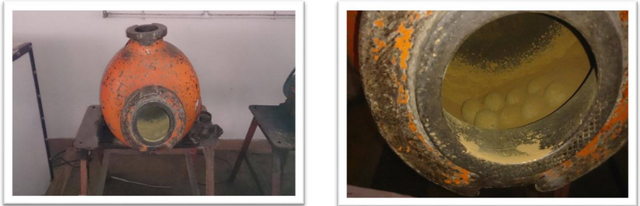
Figura 11 Molino de bolas junto con el mineral secundario en su interior.
