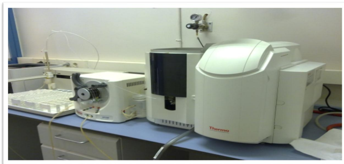
Figura 13 Espectrómetro de absorción atómica, Marca: Thermo Electron, Modelo: Solar S2.
