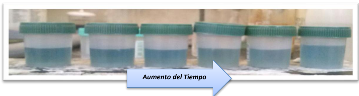
Figura 19 Alícuotas tomadas para el ensayo de lixiviación a 0.3 M
