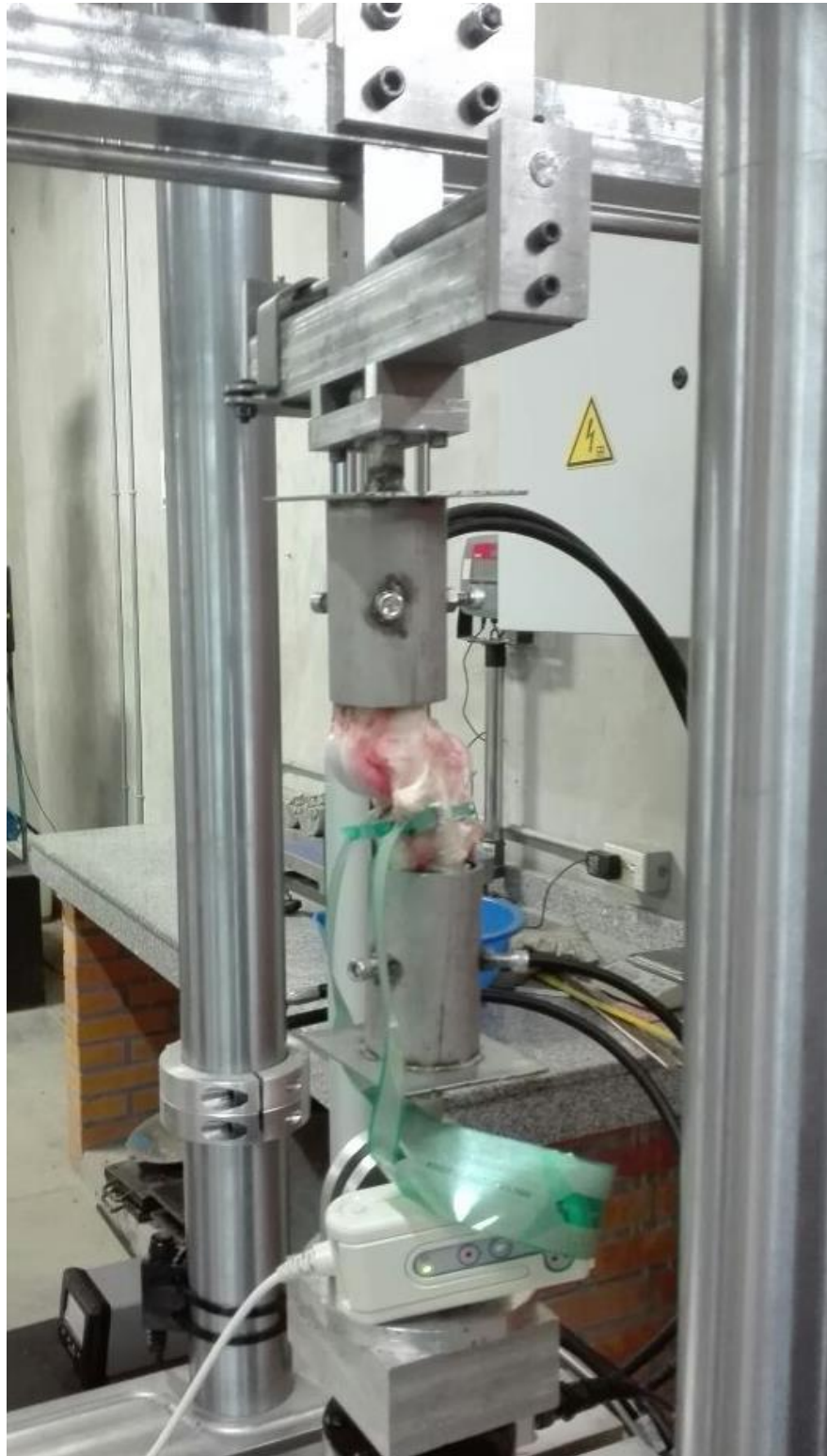
Figura 25. Ubicación del modelo porcino en la máquina de ensayos universal.
