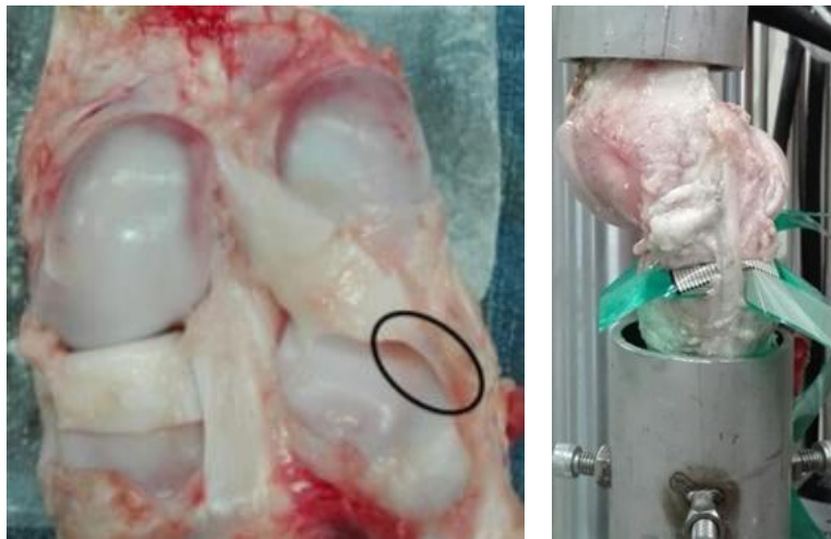
Figura 18. Muestras preparadas para ubicación de sensores.
