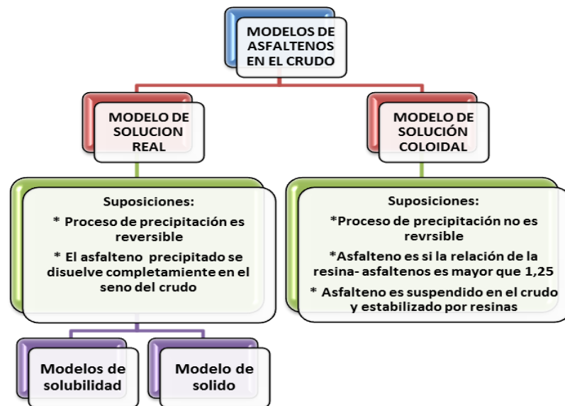
Figura 26. Esquema de los principales modelos de precipitación de asfaltenos
