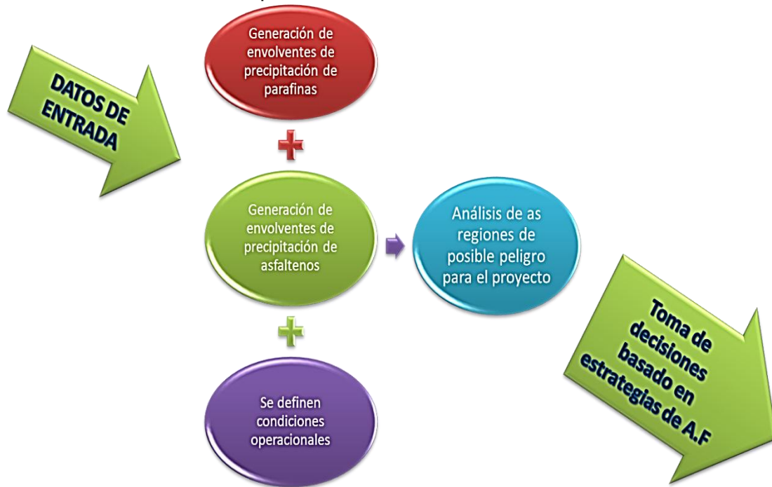
Figura 111. Integración de herramientas tecnológicas (software) para la evaluación de fases alternas sólidas en la producción.
