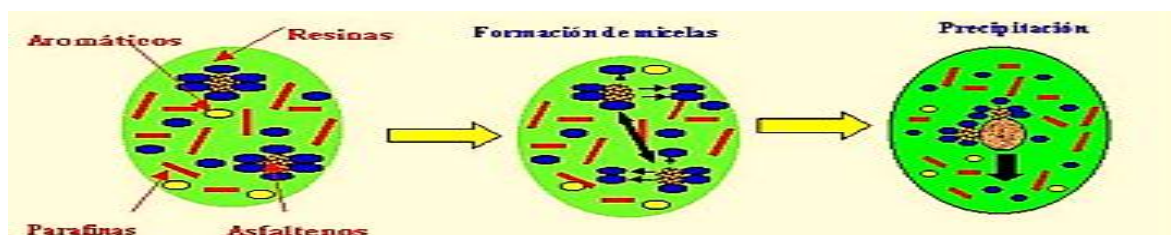
Figura 20. Mecanismo básico de precipitación de asfaltenos
