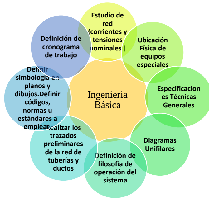
Figura 3. Principales alcances de la ingeniería básica. Adaptado de (ACIEM, 2015)
