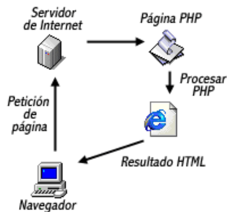
Figura No. 3 Ejecución de un programa PHP
