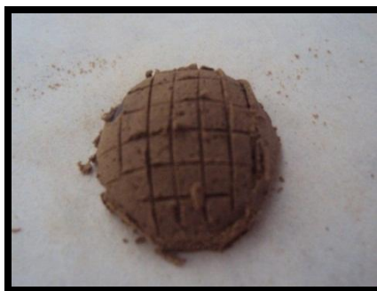
Fotografía 4. Prueba de adherencia según la norma ASTM D 3359
