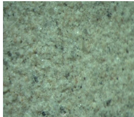
Recubrimiento Chamota-agua. 4.5x (90 aumentos totales)
