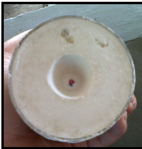
Fotografía 6. Molde de yeso con la esmeralda pre-engastada en el modelo de cera.
