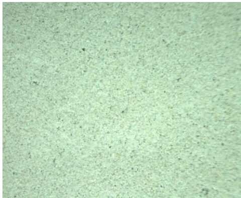
Recubrimiento Chamota-agua. 0.67x (13.4 aumentos totales)
