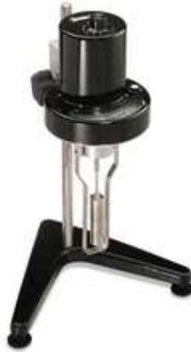
El procedimiento para la realización de las pruebas se puede describir brevemente como sigue. Se inicia con la transferencia de 16 ml de la solución a la copa, se ajusta la velocidad deseada en el selector de velocidad, empezando desde la más baja hasta la más alta, luego se sumerge la copa en un baño de temperatura constante y se empieza la rotación. Durante la prueba se registra la velocidad de rotación y la lectura del dial.
