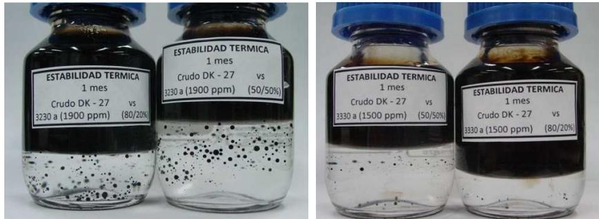
Los tiempo de prueba fueron los mismos (15, 30,60 y 90 días), al igual que el esquema de las pruebas. La estabilidad química y térmica de las soluciones se expresa en el porcentaje retenido de la propiedad seleccionada (viscosidad, filtrabilidad, screen factor, etc) después de un periodo expuesto a temperatura elevada. La propiedad debe ser medida al principio y al final a temperatura ambiente o a la temperatura seleccionada para el experimento.
