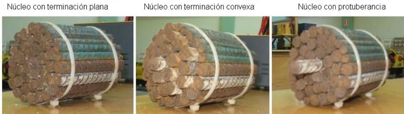
Figura 6.6: Prototipos para escoger la forma óptima del núcleo.
