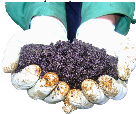
Figura 4.2: Muestra de depósito parafínico recolectado de Col-25.
