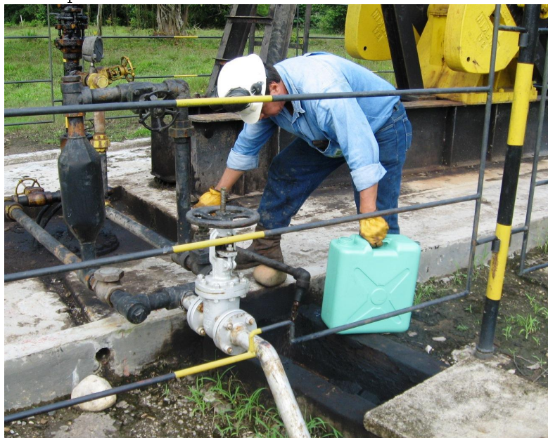
Figura 4.5: Operario realizando maniobras de muestreo en cabeza de pozo.
