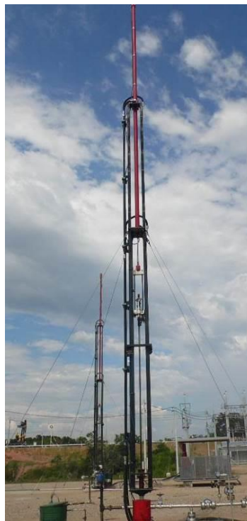
Figura 18. Fotografía conjunto Mástil – Cilindro- Carro Viajero
