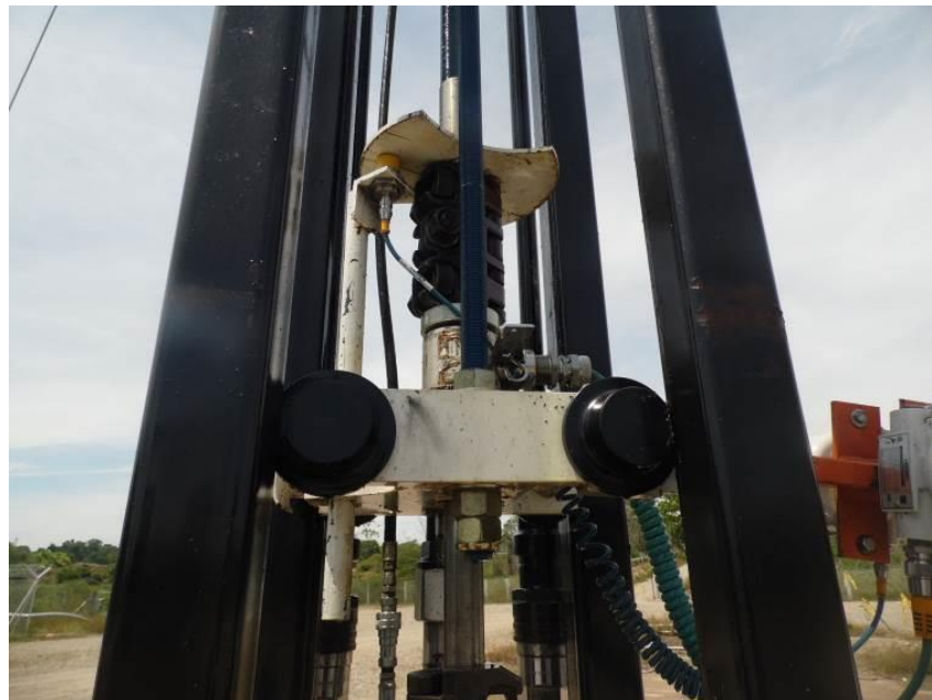
Figura 25. Fotografía conjunto Plato de separación, sensor de proximidad, grapa, carro viajero y barralisa
