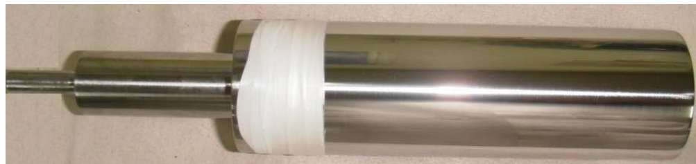
Figura 20. Cátodo fabricado de acero inoxidable 304
