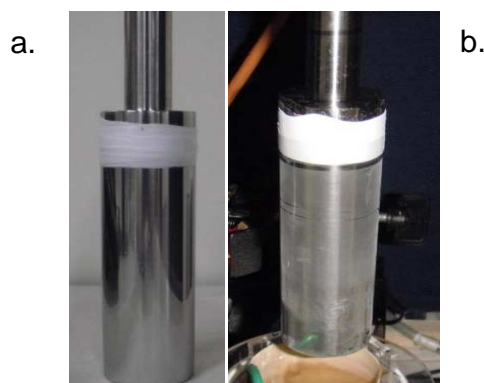
Figura 29. Superficie del cátodo: a) antes, b) después, de la fotoelectrólisis de la solución 1.
