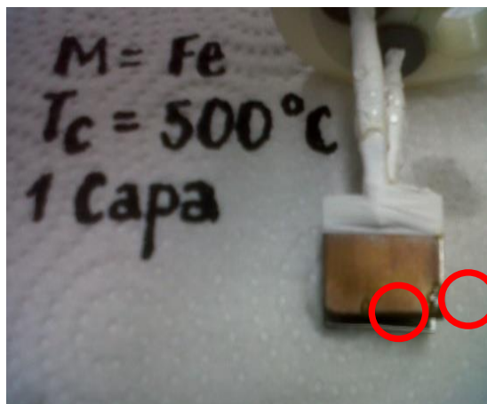
Figura A4. Fotografía de la película de Bi-Nb-Fe-O/304 SS después de realizados los experimentos fotoelectrocatalíticos donde se observa la deposición del precipitado formado (círculos rojos).
