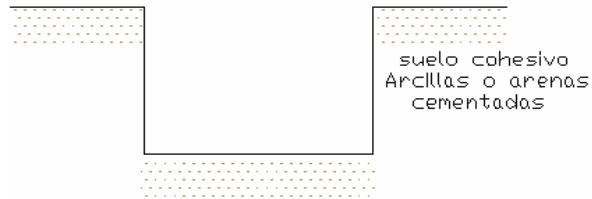
Grafica 80. Talud vertical en suelo cohesivo
