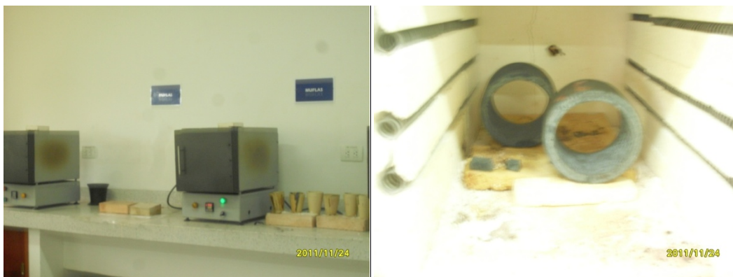
Figura A7 Mufla del Laboratorio de Pirometalúrgia Escuela de Ingeniería Metalúrgica y Ciencia de Materiales, Edificio Planta de Aceros Álvaro Quiroga Correa, de rampas donde se realizó el normalizado y el revenido.
