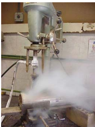
Figura 2.2. Procedimiento para corte y preservación de muestras friables.
