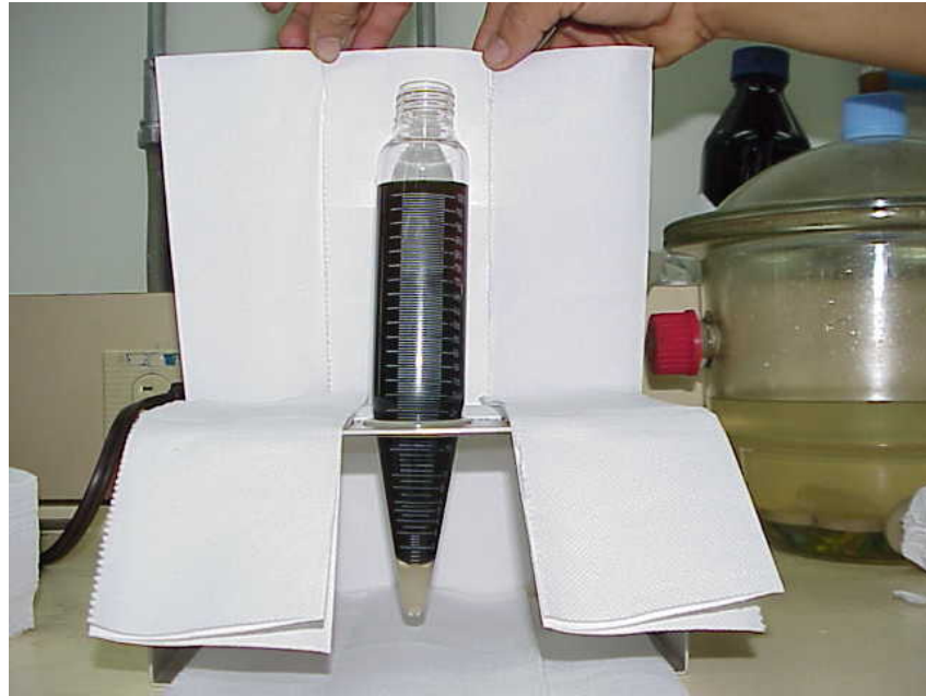
Figura 2.11 Vista inferior del permeámetro detalle de fluidos recolectados del desplazamiento de crudo en muestra
