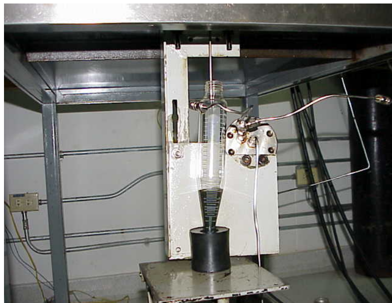
Figura 2.11 Vista inferior del permeámetro detalle de fluidos recolectados del desplazamiento de crudo en muestra
