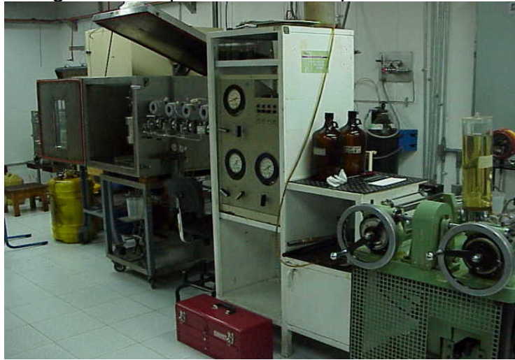
Figura 2.7 Visión general del permeámetro empleado en los desplazamientos
