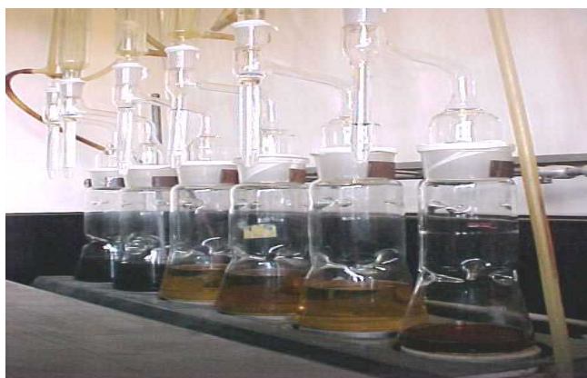
Figura 2.3. Equipo Dean Stark para determinación de la saturación de los fluidos.
