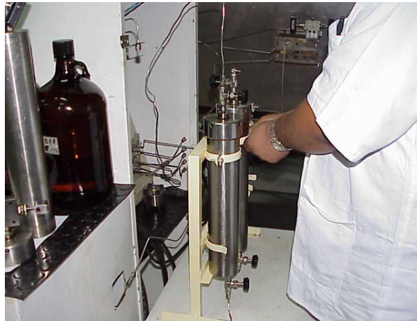
Figura 2.12 Vista posterior del permeámetro con sus cilindros dispuestos con crudo mineral y salmuera
