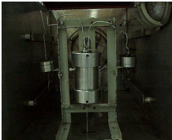
Figura 2.8 Disposición de la muestra dentro de "Core Holder" del permeámetro
