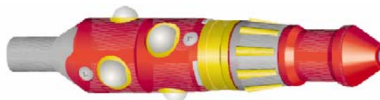
Figura 13.11. Herramienta ajustable de expansión (CRES). Tomado de “Expandable Systems”. Weatherford W Magazine October 2000.
