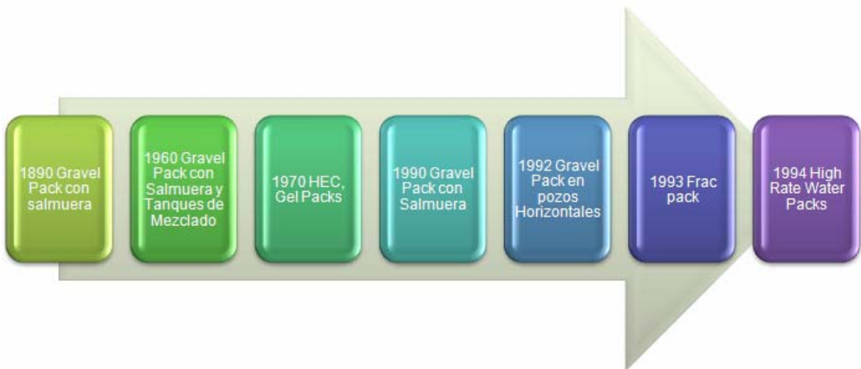
Figura 13.25. Evolución de la técnica de empaquetamiento con Grava
