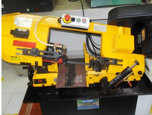
Figura 12. Equipo para corte de acero, Metal Band Saw
