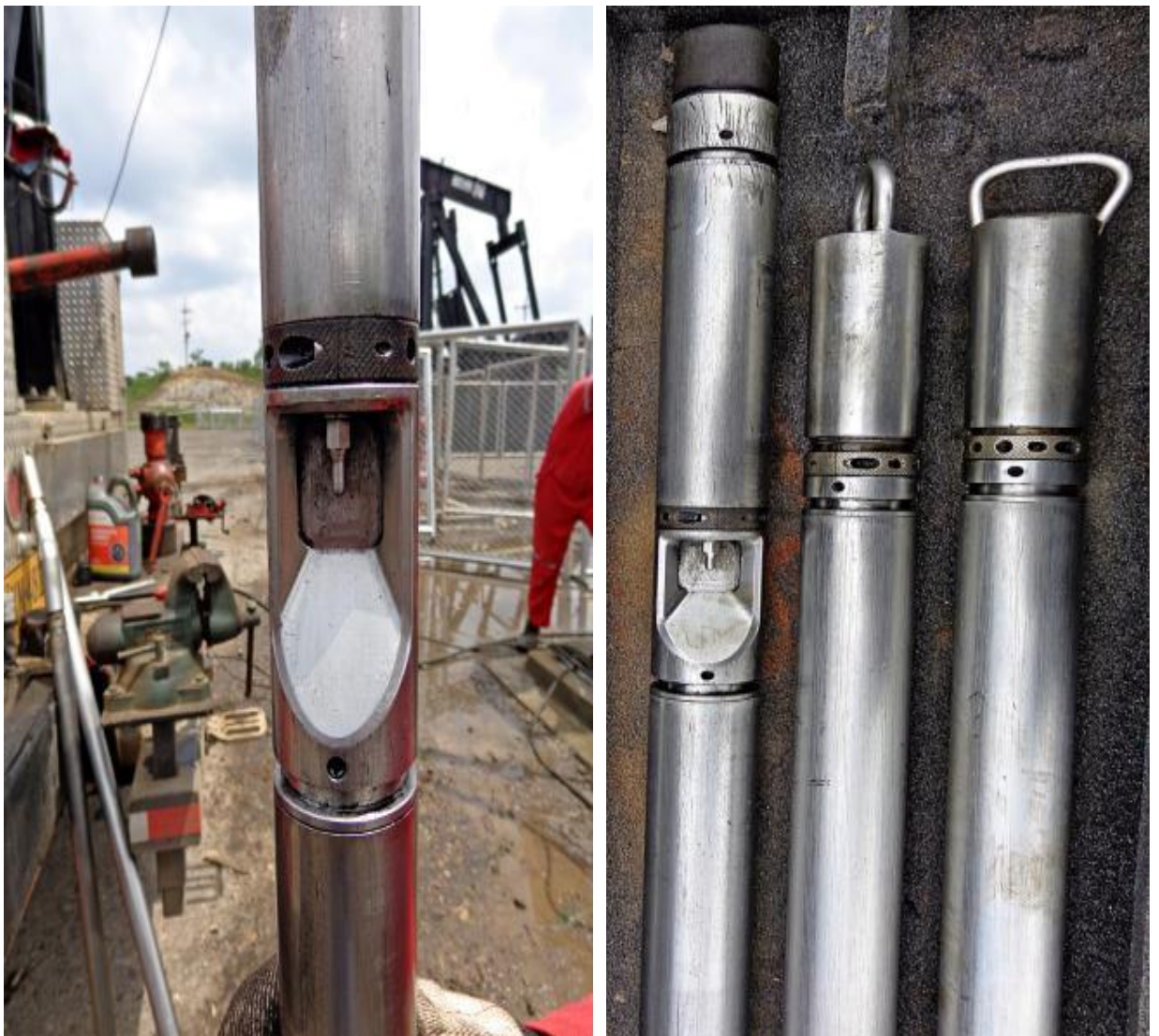
Figura 36. Sensor de Temperatura GR4 por HOTWELL COLOMBIA.
