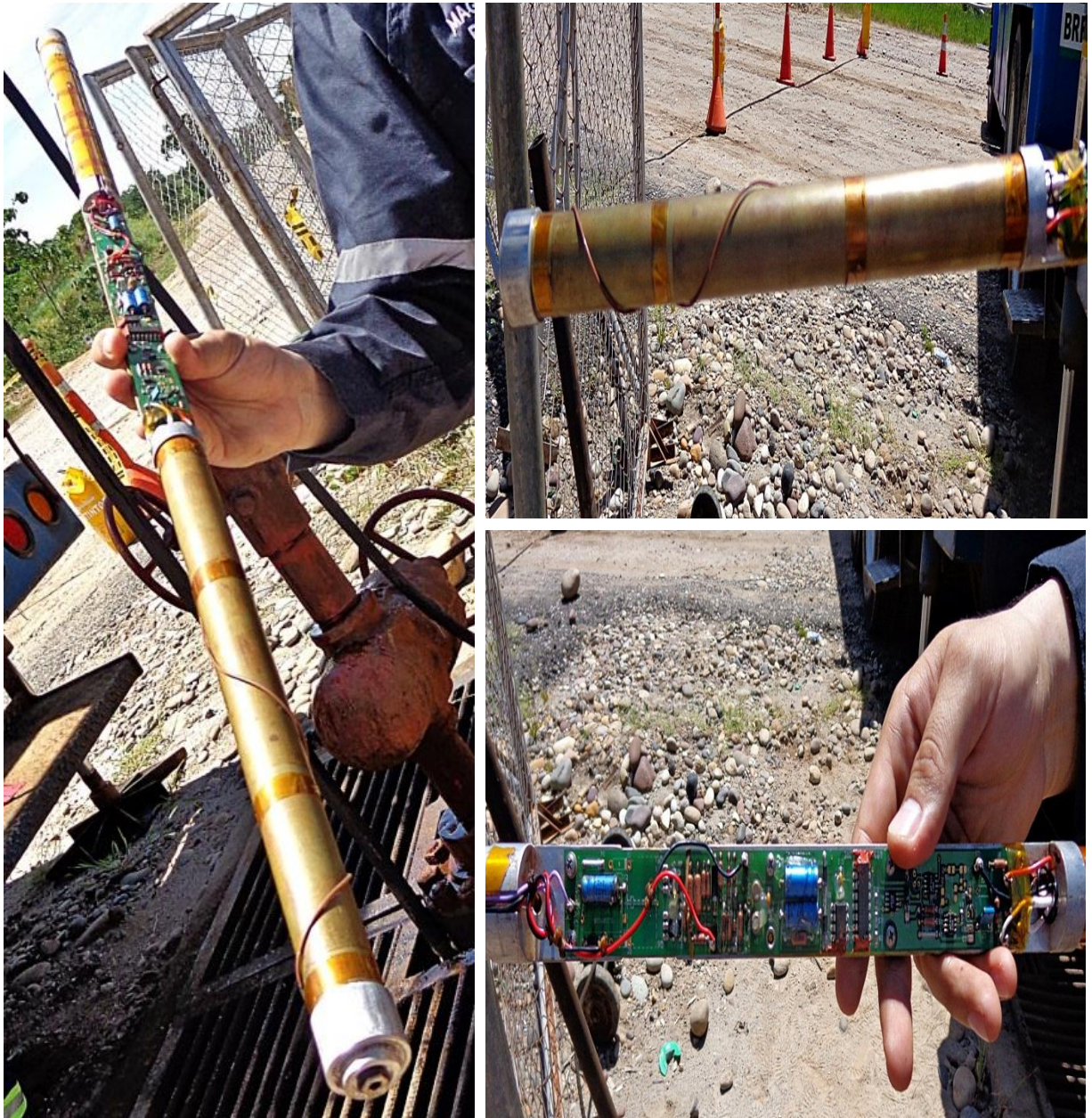
Figura 21. Detector de material radiactivo COLREGISTROS S.A.S.
