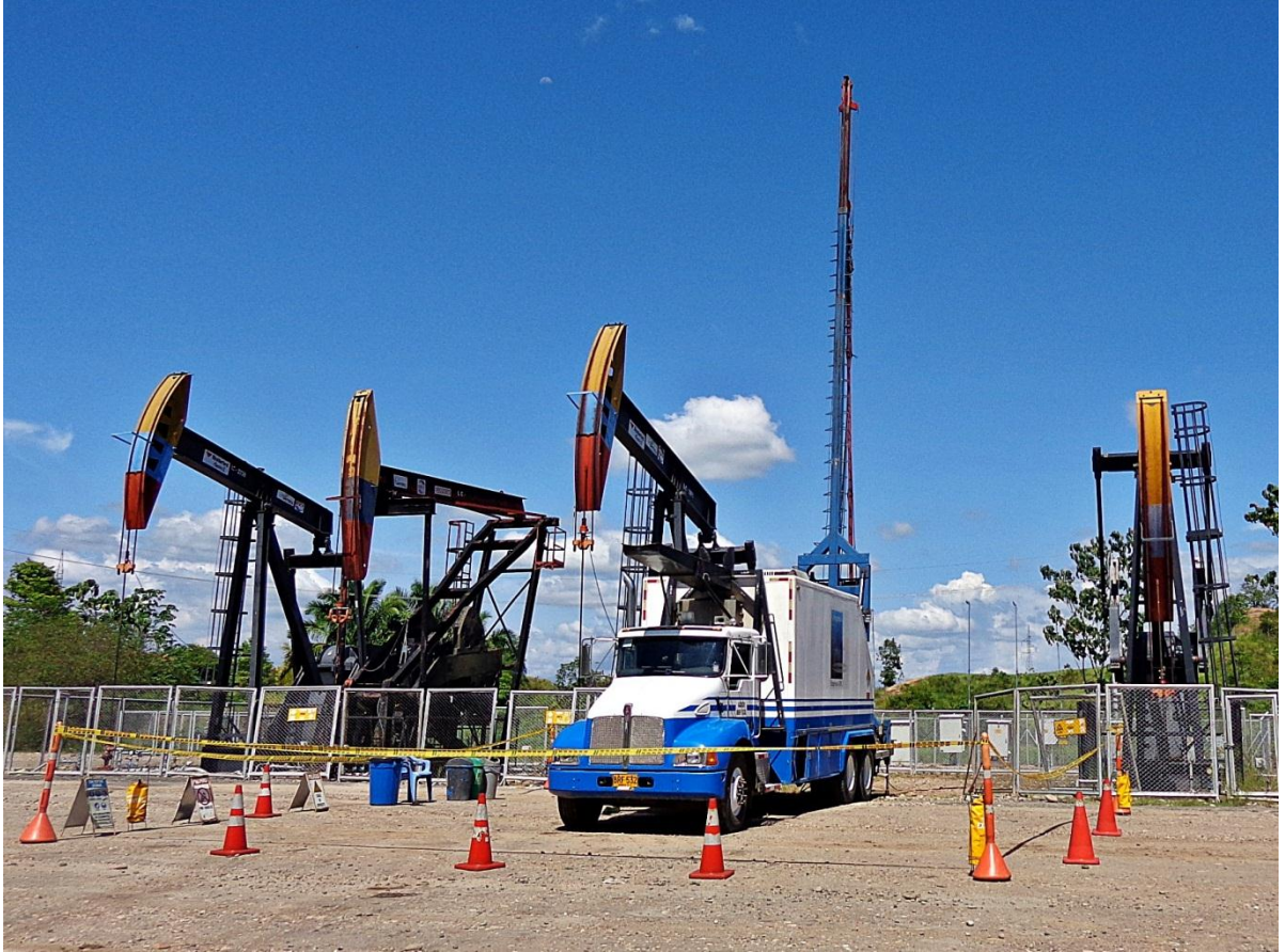
Figura 29. Anillo de seguridad en el perímetro de la operación.
