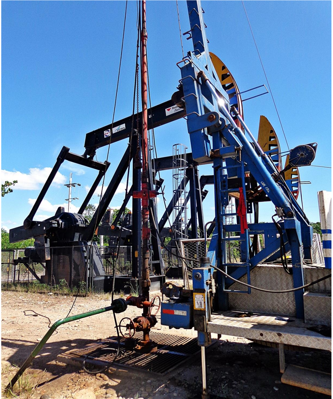
Figura 30. Acople Sarta COLREGISTROS S.A.S. al pozo inyector.
