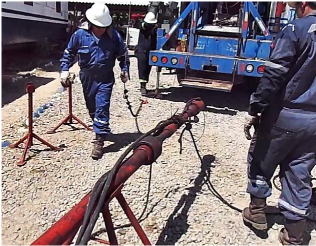
Figura 25. Montaje de la sarta a la unidad móvil de COLREGISTROS S.A.S.
