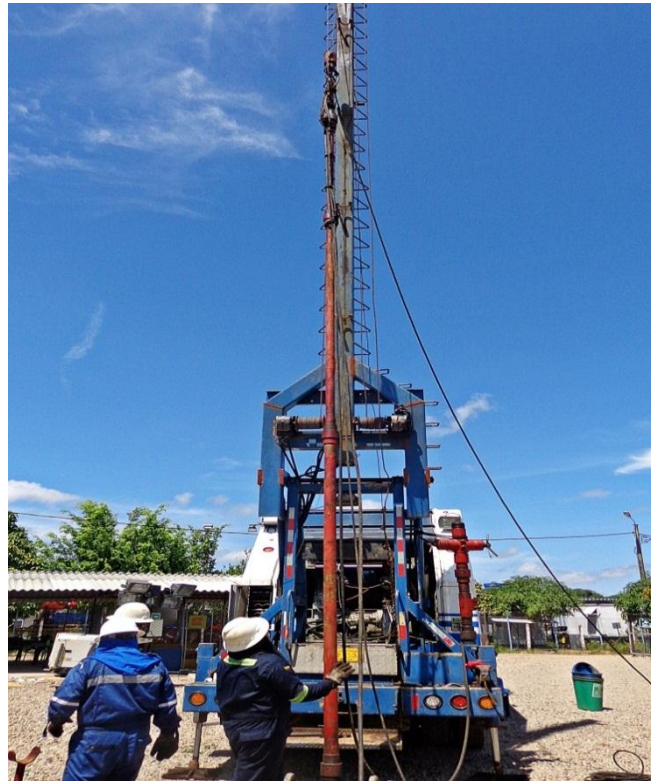
Figura 25. Montaje de la sarta a la unidad móvil de COLREGISTROS S.A.S.
