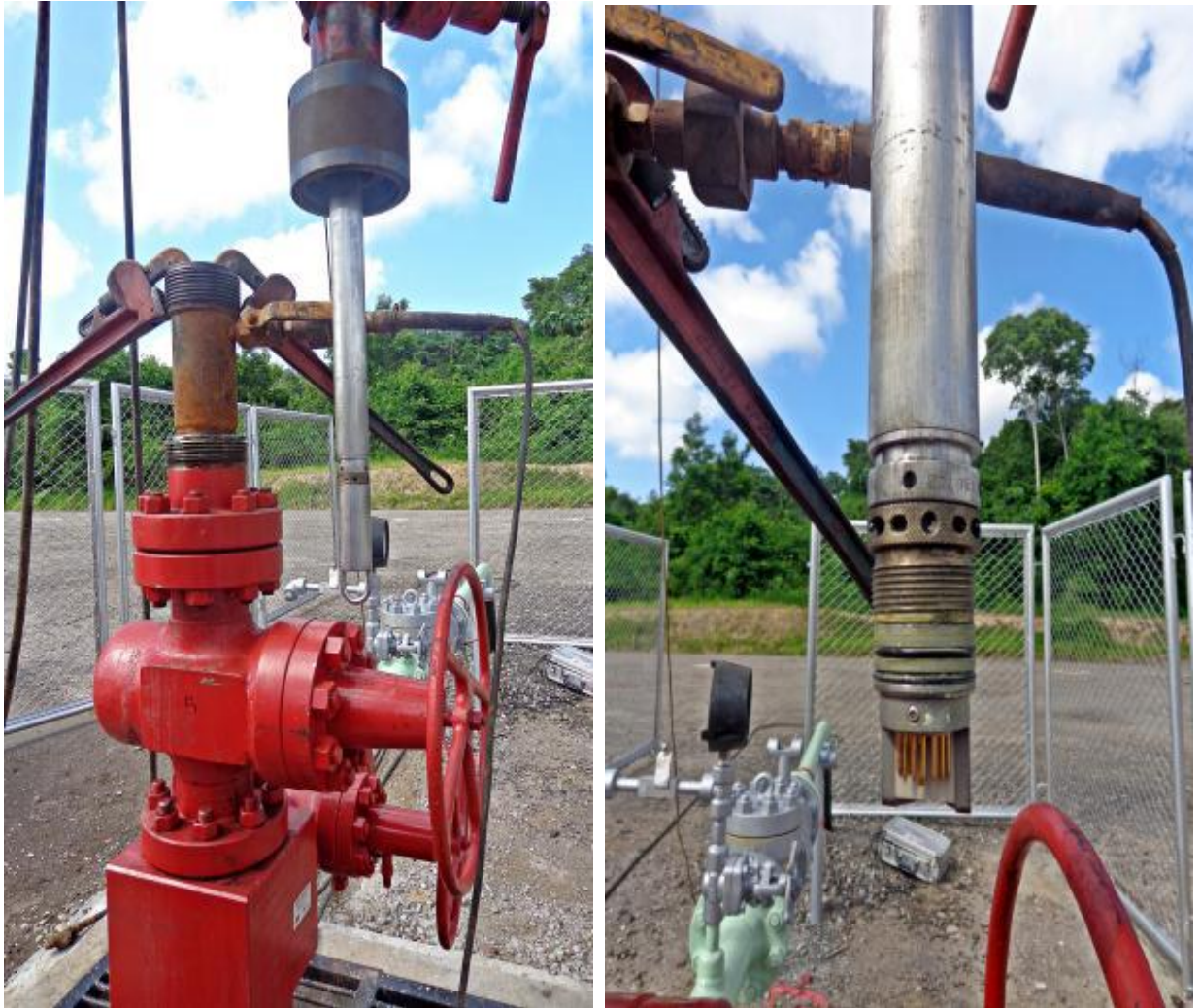
Figura 35. Ensamblaje entre detectores Gamma Ray por HOTWELL COLOMBIA.
