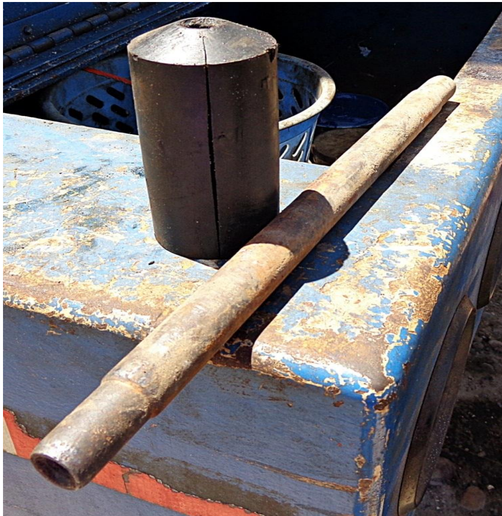
Figura 20. Herramienta eyectora de material radiactivo COLREGISTROS S.A.S.
