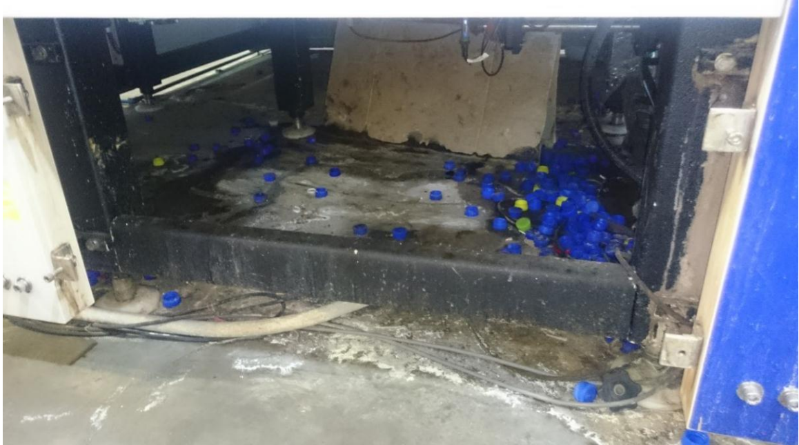
Figura 39. Fuente de contaminación, desperdicio de tapas dentro de guardas.
