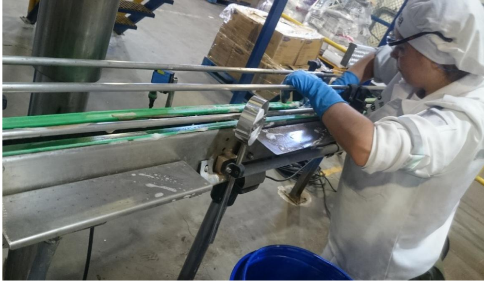
Figura 48. Limpieza de banda para remoción de óxido, realizada por el operador.
