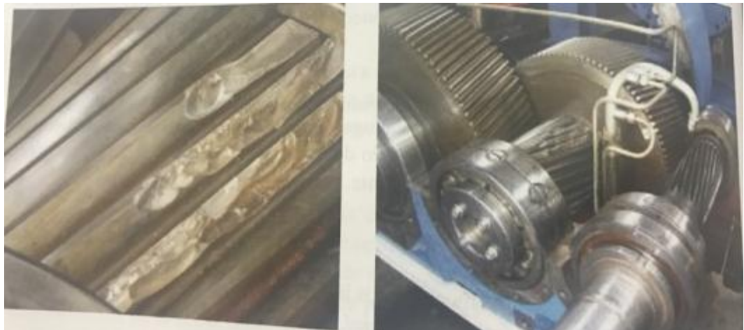
Figura 11. Fractura por sobrecarga
