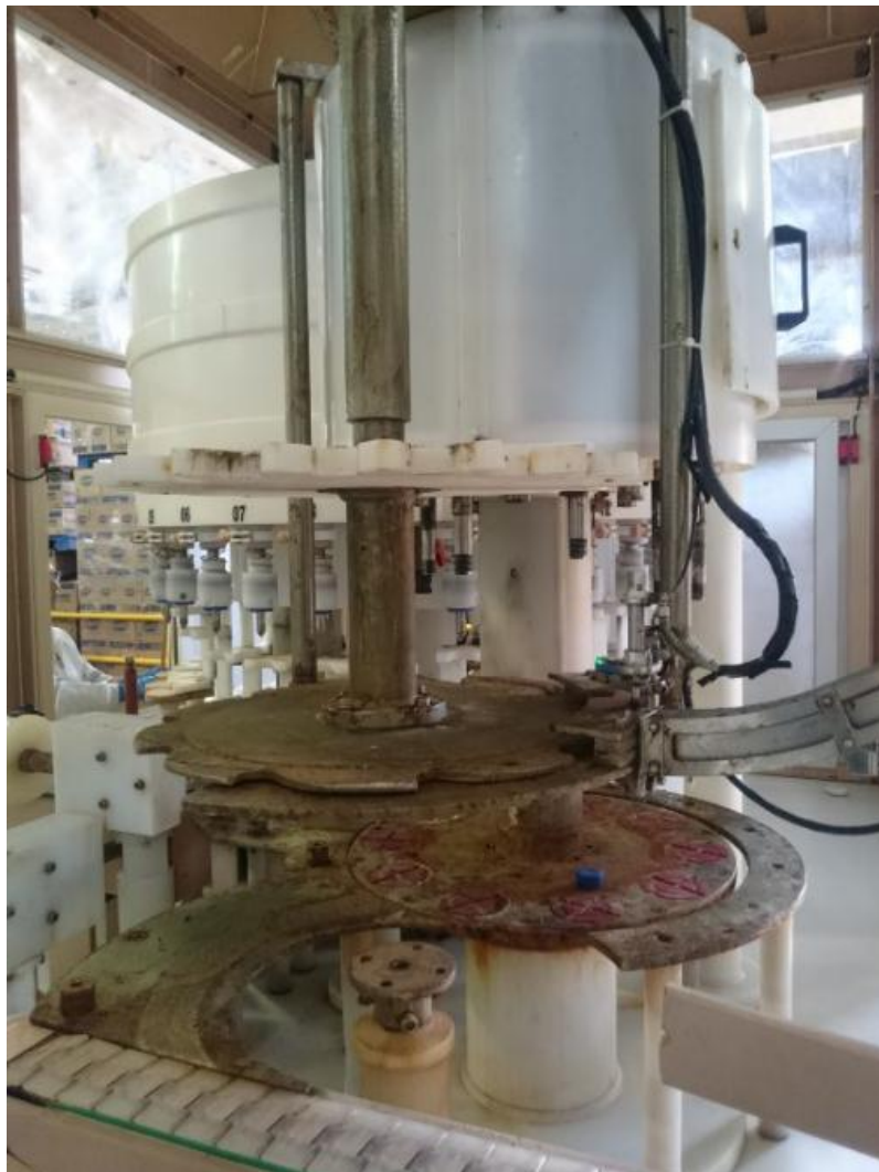
Figura 38. Oxidación de juego de manejo para botella.
