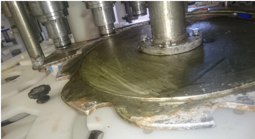
Figura 49. Remoción de óxido y aplicación de decapante para sellado.
