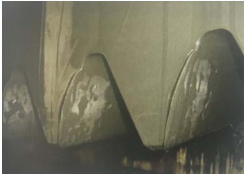
Figura 13. Falla por flujo plástico
