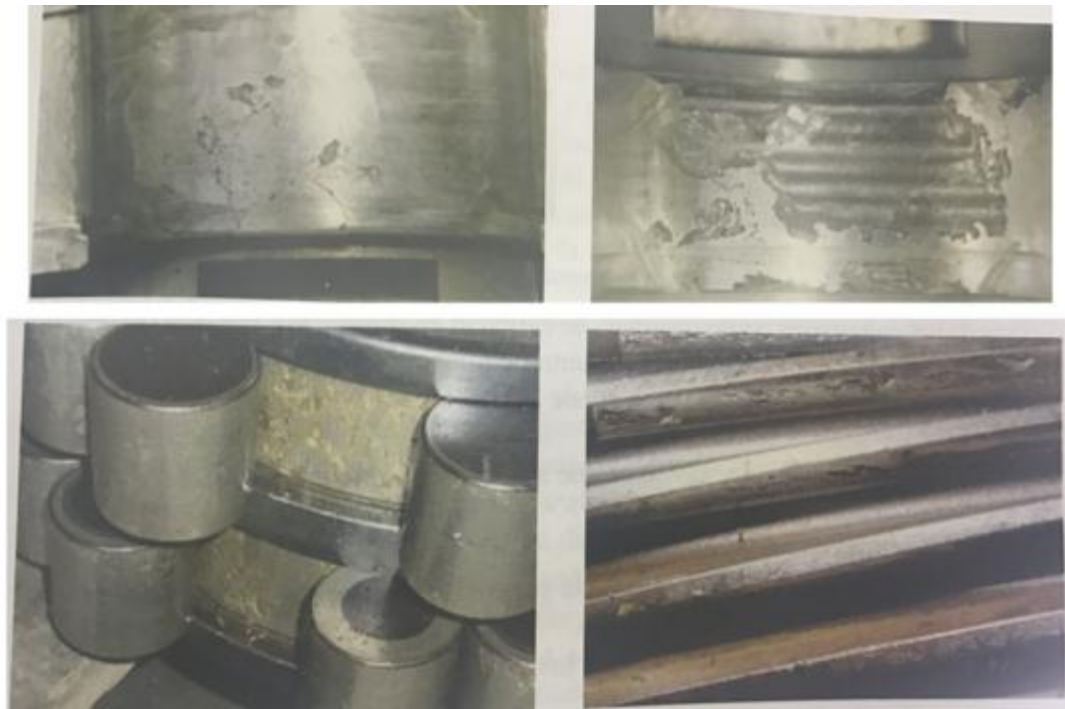
Figura 12. Falla por fatiga superficial
