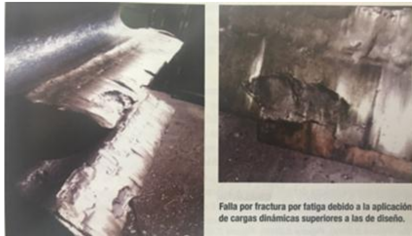
Figura 10. Falla por fractura por fatiga
