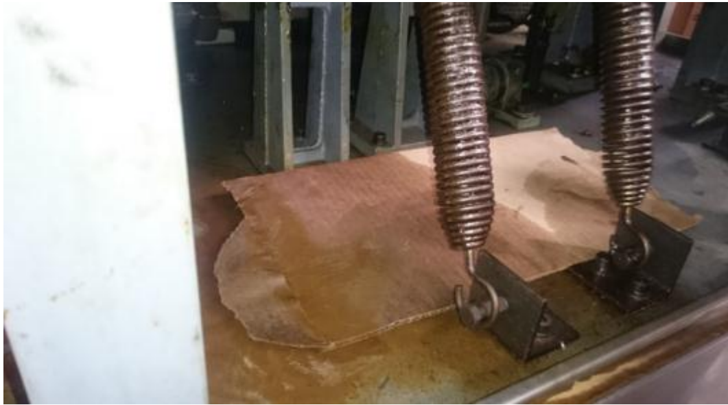
Figura 60. Cartones encontrados tapando derrames, mucha contaminación de aceite
