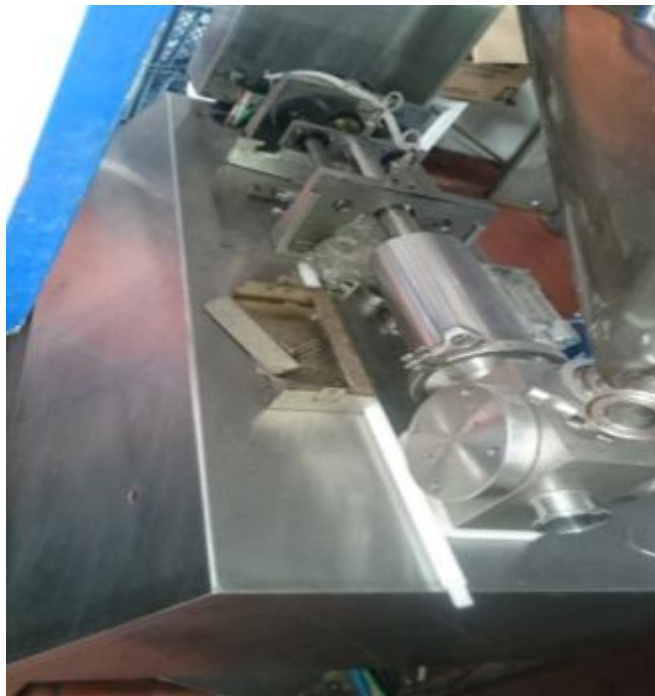
Figura 61. Segundo sistema servomotor desinstalado
