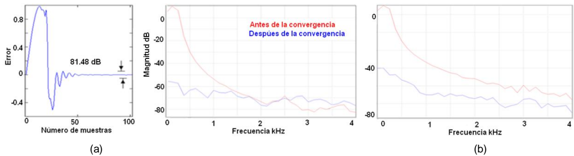
Gráfica 15. Señal de Error y Espectro residual de la señal de "voz" para (a) A = 0,8 , N = 32 , varianza = 0,1 , \tau_e = 1,88\text{ms} y (b) A = 1 , N = 32 , varianza = 0,8 , \tau_e = 1,16\text{ms} .
