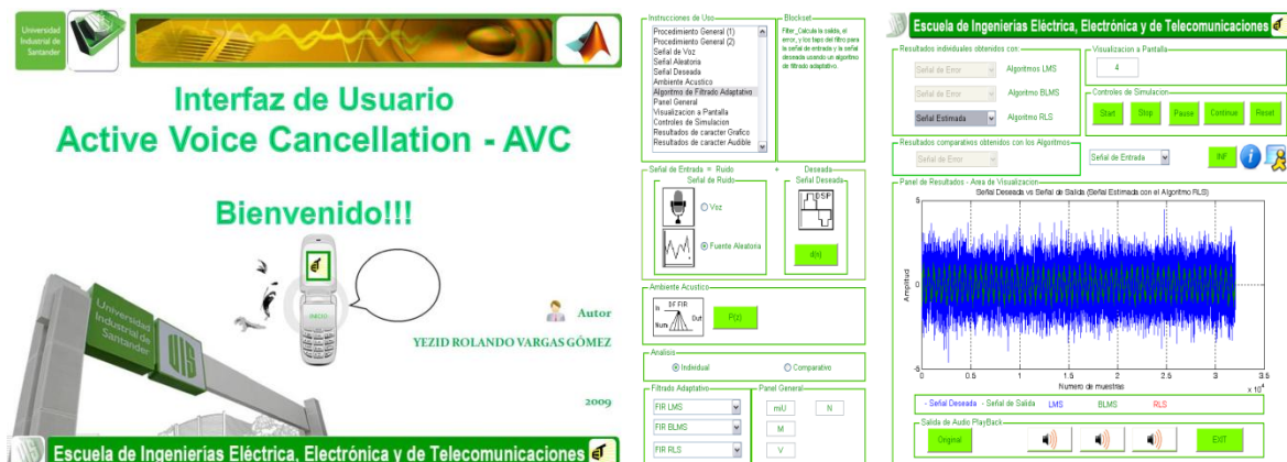
Figura 11. Pantalla Principal de la Interfaz Gráfica de Usuario implementada en MATLAB® para el sistema de Cancelación Activa de Voz.
