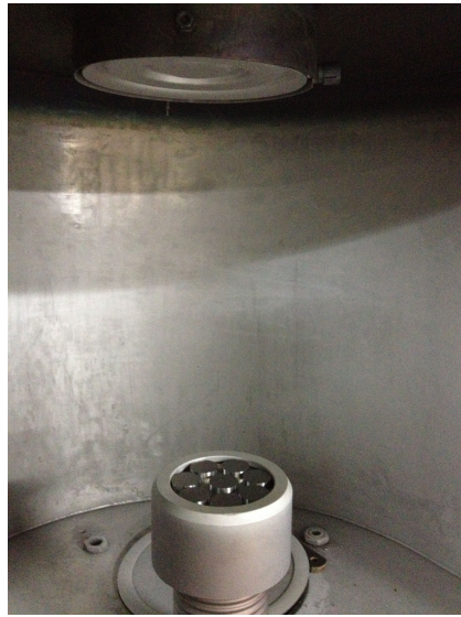
Figura 2.3: Cupones en el cátodo de la cámara de descarga del reactor JUPITER.
