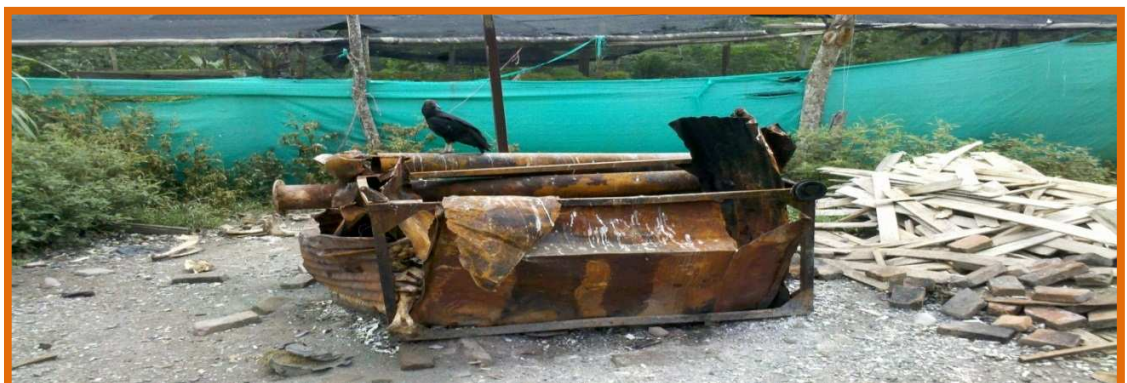
Fotografía No. 15. Horno incinerador, de huesos, cascos, cuernos.
