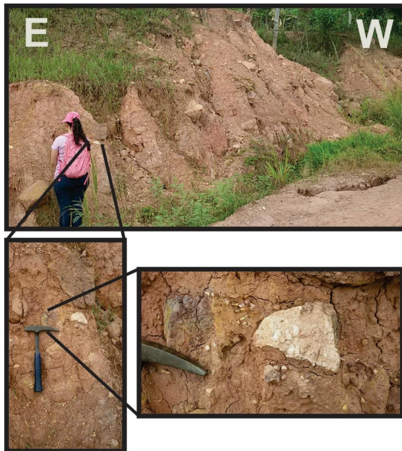
Figura 9. Suelo transportado coluvial inactivo (Stci), con presencia de bloques, cantos, gravas pertenecientes a la Formación Girón.
