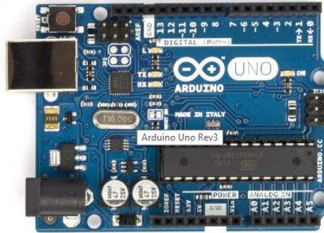
Figura 4. Tarjeta de desarrollo arduino uno r3, empleada para el análisis de datos. Fuente [9]
