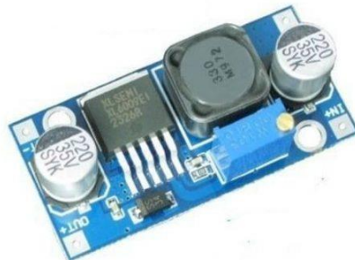
Figura 7. Convertidor dc-dc set-up elevador de tensión xl6009. Fuente [12]
