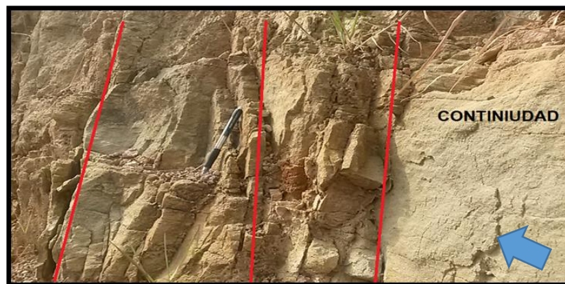
Figura 17. Ejemplo de la continuidad de las discontinuidades.
