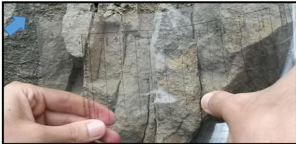
Figura 19. Ejemplo de la rugosidad – ondulación de las discontinuidades mediante la comparación visual con los perfiles estándar de rugosidad sacados .
