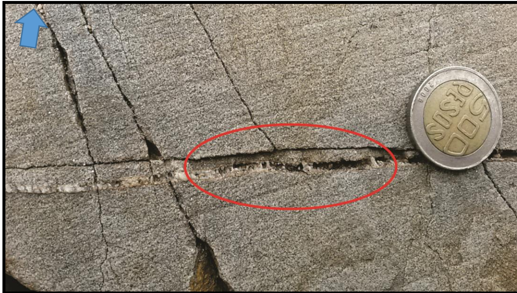
Figura 20. Ejemplo de la rugosidad de las discontinuidades.
