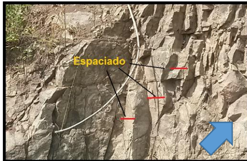
Figura 16. Ejemplo del espaciado de las discontinuidades en el afloramiento No.3.
