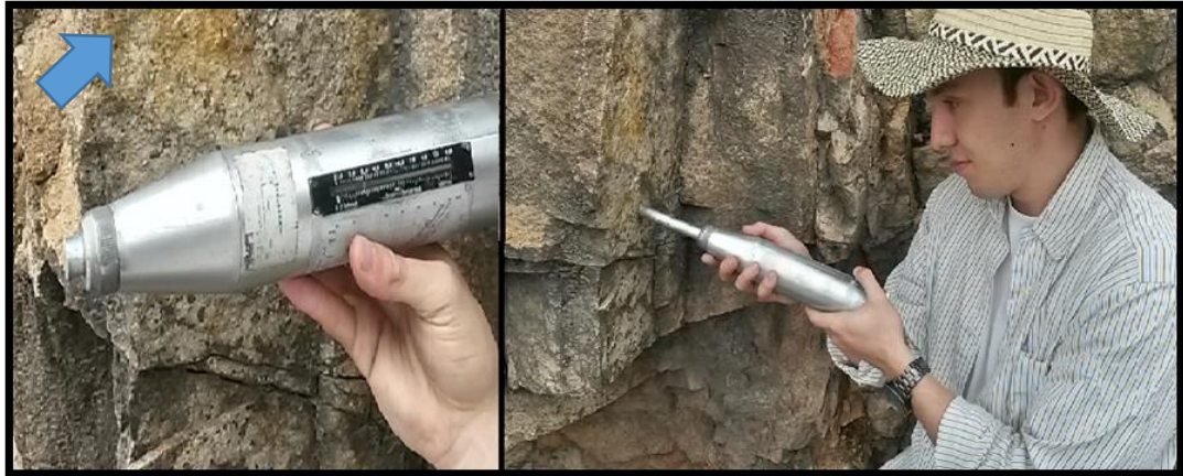
Figura 21. Medición de la resistencia de las paredes de la discontinuidad en el afloramiento No 3 usando el martillo Schmidt.
