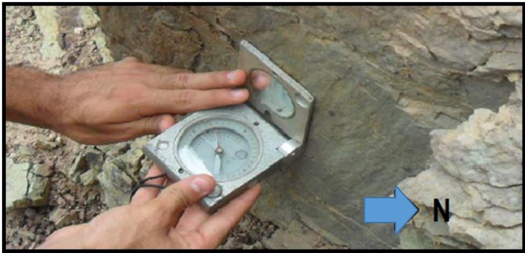
Figura 15. Toma de datos estructurales de rumbo y buzamiento.
