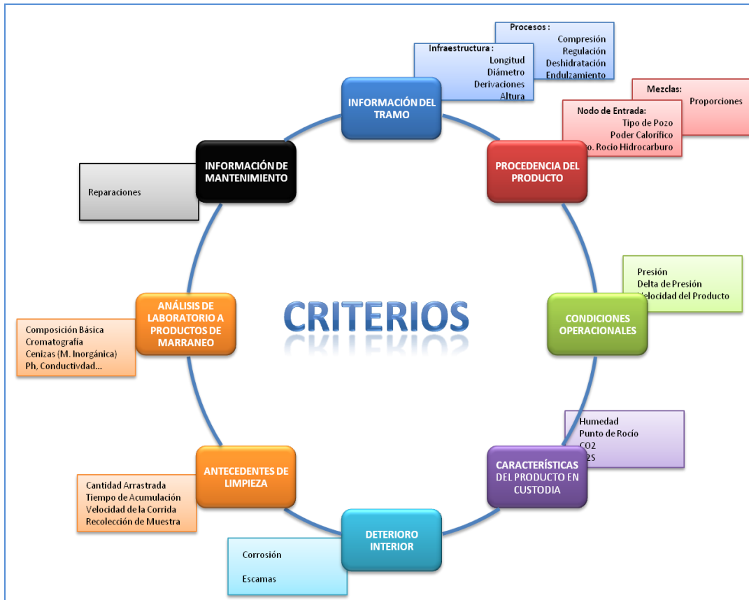
FIGURA 7 PARÁMETROS QUE PUEDEN INCIDIR EN LOS PROCESOS DE CORROSIÓN INTERNA Y GENERACIÓN DE SUCIEDAD EN UNA LÍNEA DE TRANSPORTE DE GAS NATURAL.
