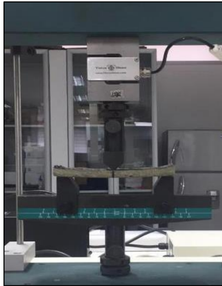
Figura A2. Montaje de prueba de flexión. Tomada en el laboratorio del GIMAT de la Universidad Industrial de Santander. Escuela de Ingeniería Metalúrgica.
