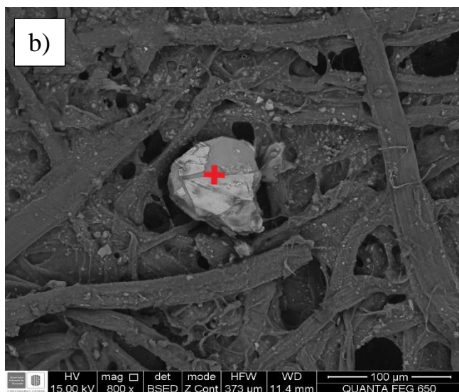
Figura 8. Análisis químico por espectrometría de dispersión de energía de Rayos-X del panel de celulosa por dentro (fibras). a) Partícula dentro de las fibras del panel a 400 um y b) partícula dentro de la fibra del panel a 100 um.
