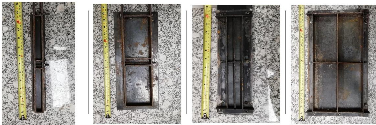
Figura A5. Molde hecho en acero para la fabricación de los paneles.
