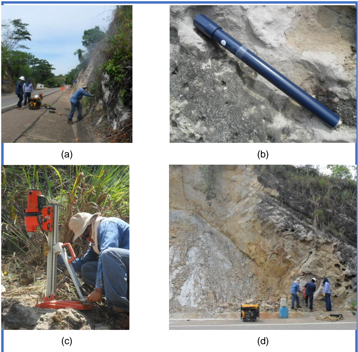
Figura 17. Equipo de perforación: (a) Planta eléctrica; (b) Broca corazonadora; (c) Taladro saca núcleos; (d) Tanques de agua.
