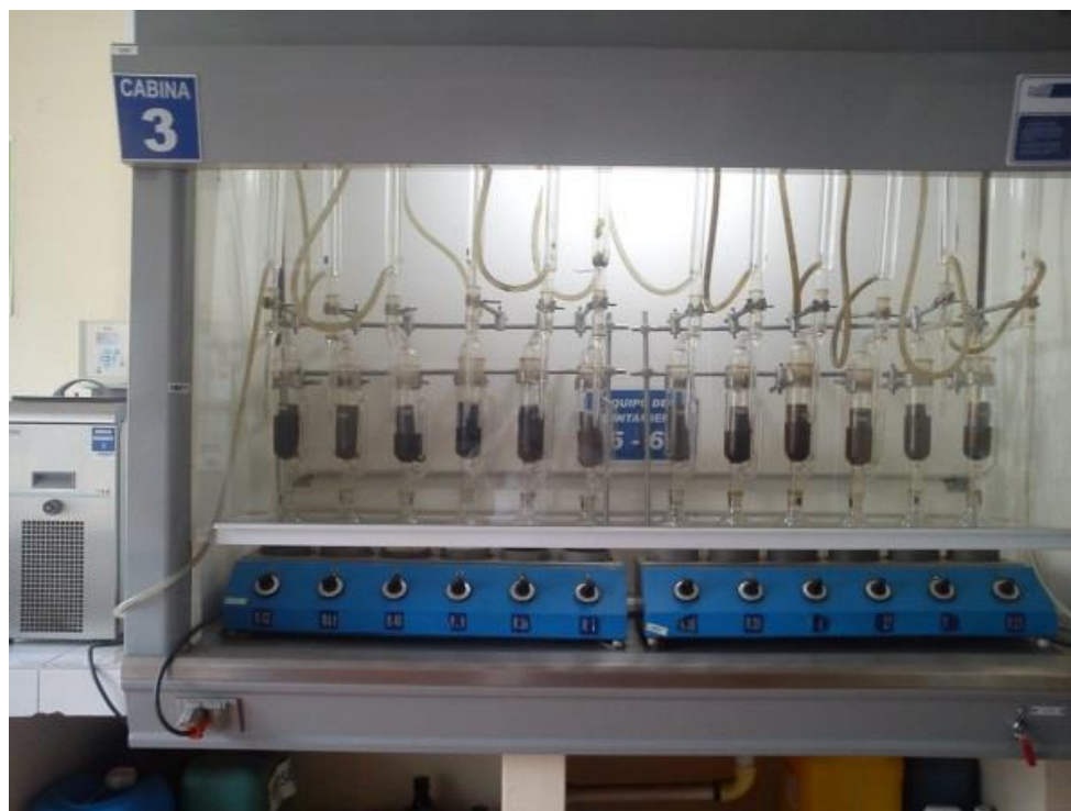
Foto 24. Muestras en el extractor Deanstark–Soxhlet.
