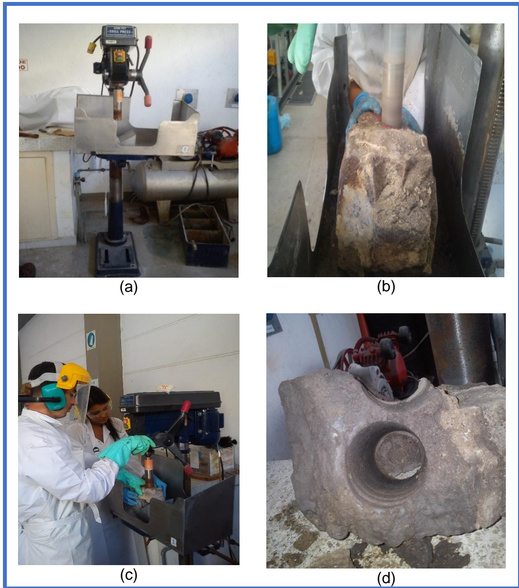
Figura 31. Perforación de bloques rocosos: (a) prensa taladradora con broca diamantada; (b) (c) inicio de la perforación; (d) bloque rocoso después de la perforación.
