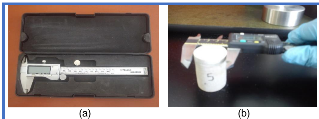
Figura 29. (a) Calibrador digital; (b) medición de dimensiones del plug.
