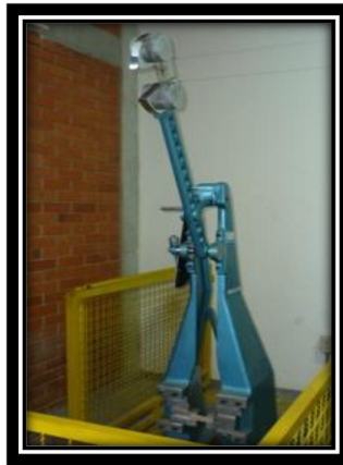
Figura 22. Equipo para ensayo de impacto.
