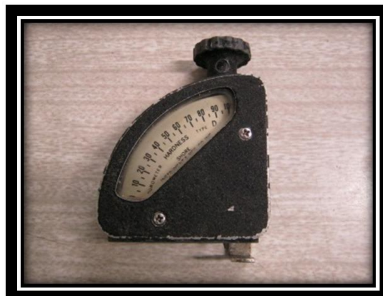
Figura 23. Equipo para ensayo de dureza.
