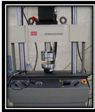
Figura 20. Equipo para ensayo de compresión.
