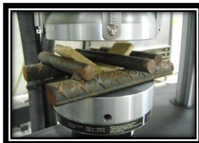
Figura 21. Equipo para ensayo de flexión.
