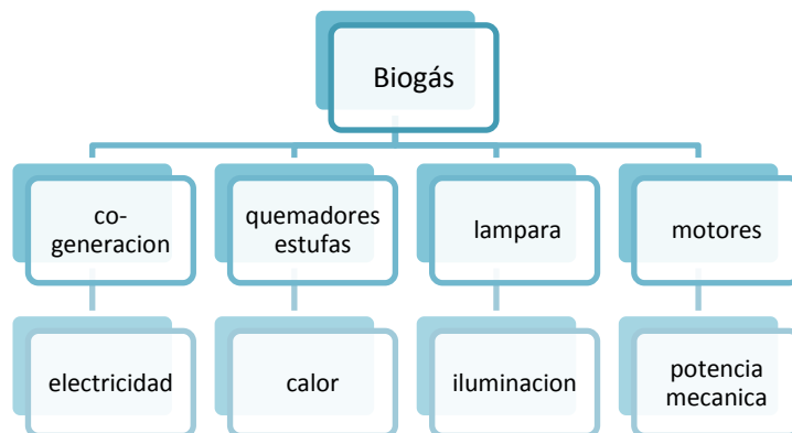
Figura 2. Usos del biogás
