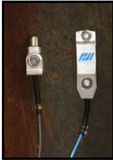
Imagen 12. Equipo analizador de hinca PDA*.
