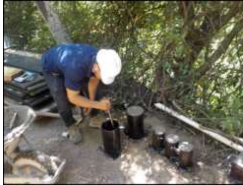
Figura 15. Elaboración de especímenes de concreto en obra.
