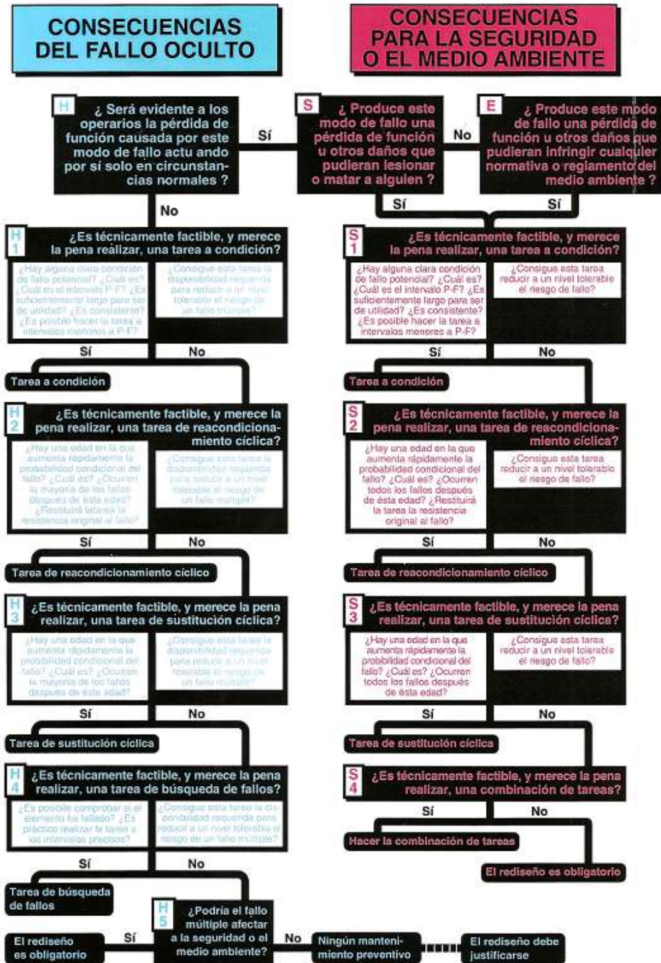
Figura 24. Consecuencias del fallo oculto y consecuencias para la seguridad o el medio ambiente.
