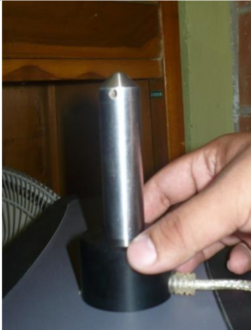
Figura 8. Detalle Terminal para conexión Diver del USB Diver Reading
