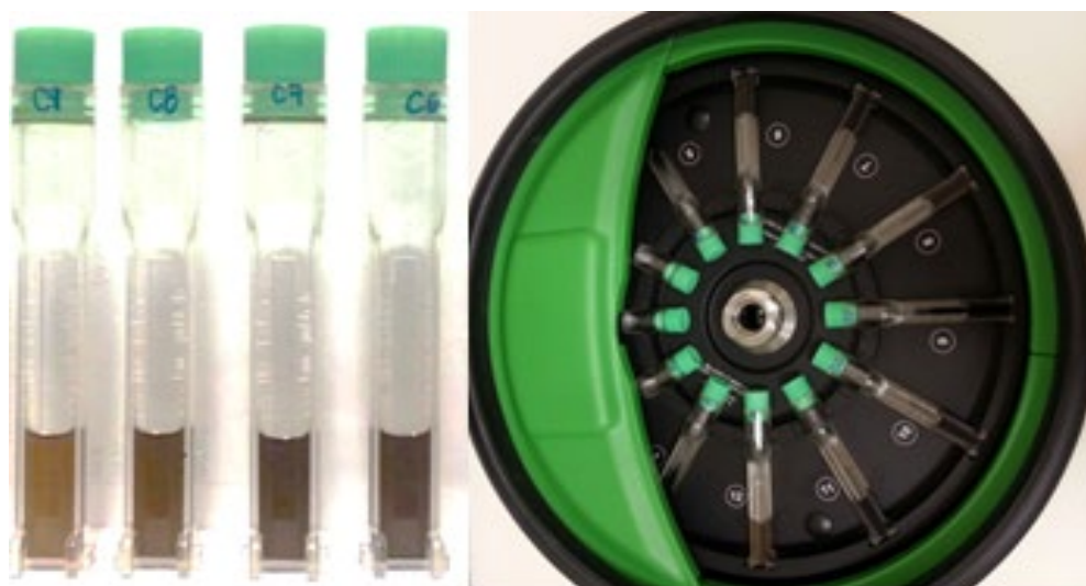
Figura 4.3 Porta–muestra múltiple del analizador de dispersión LUMiSizer
