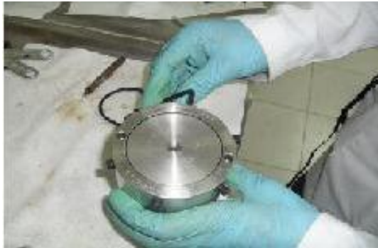
Figura 34. Cerrado de cámara HPHT con fluido de perforación
