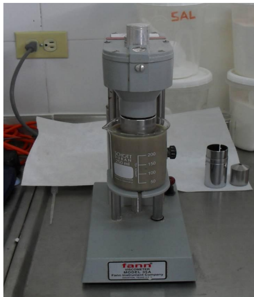
Figura 21. Prueba reológica del fluido de perforación
