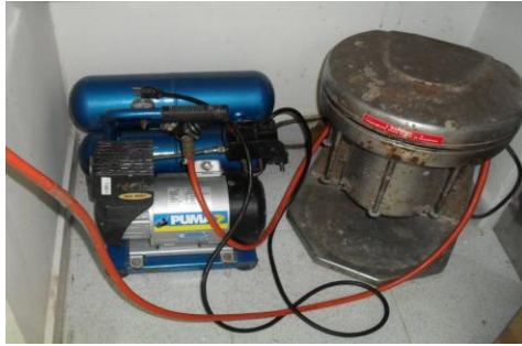
Figura 23. Compresor de la filtro-prensa API
