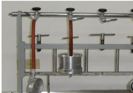
Figura 26. Presurización de la cámara
