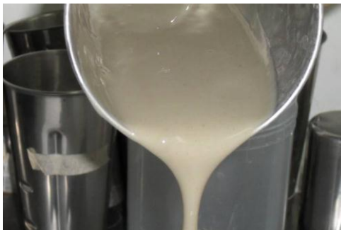
Figura 20. Vertimiento del fluido de perforación
