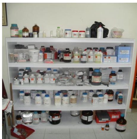
Figura 43. Almacenamiento indebido de productos peligrosos
