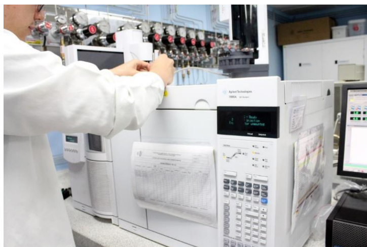
Figura 55. Cromatógrafo de gases durante la inserción de la fibra
