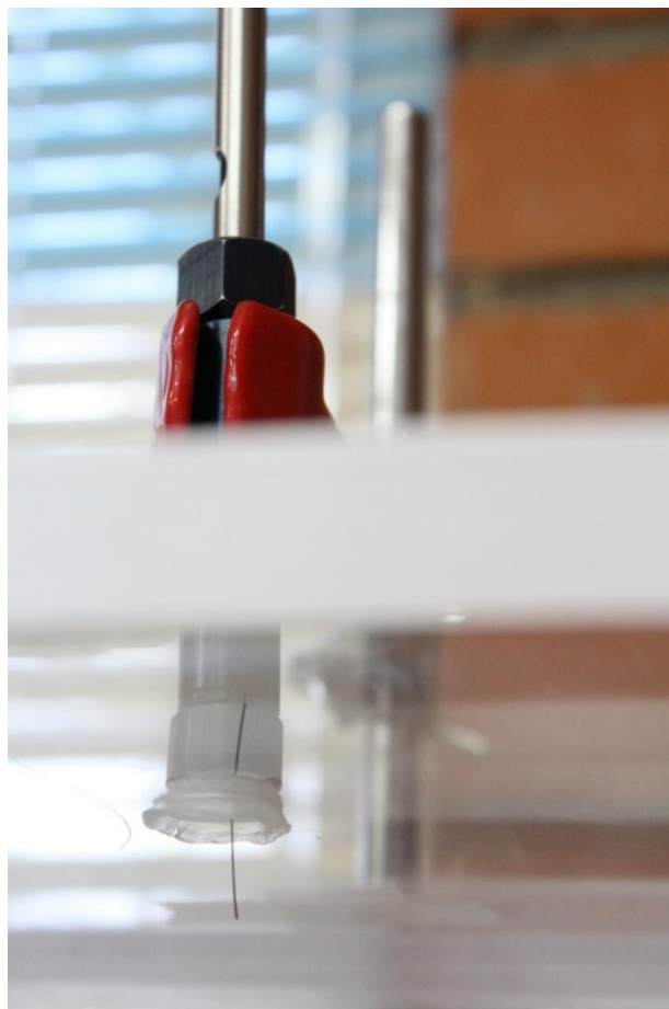
Figura 54. Fibra utilizada (CAR/PDMS) insertada en la oficina a escala
