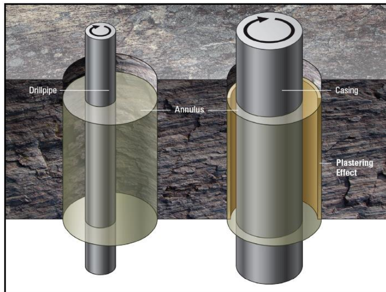
Figura 19. Anulares con Casing Drilling y Perforación Convencional
