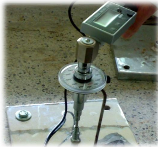
Figura 13. Ensayo de torsión realizado a probetas de aleación Tiadyne™ [7]
