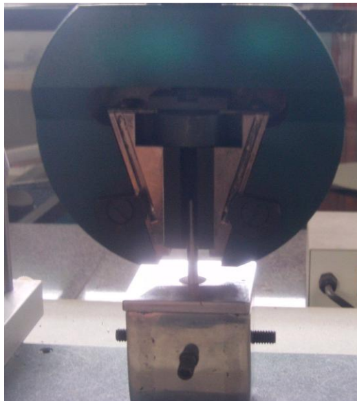
Figura 25. Montaje del dispositivo en la máquina de ensayos Tinius Olsen.
