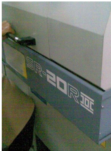
Figura 18. Torno industrial tipo Suizo 7 ejes START SR-20R
