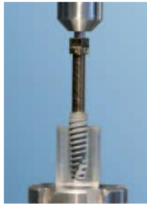
Figura 12. Imagen sobre el ensayo de torsión en el implante Nobel perfect™.
