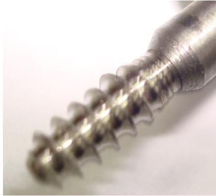
Figura 19. Implante de Ti6Al4V fabricado en el torno CNC Marca RS 20R y detalle de acople de la cabeza del implante a la llave de sujeción
