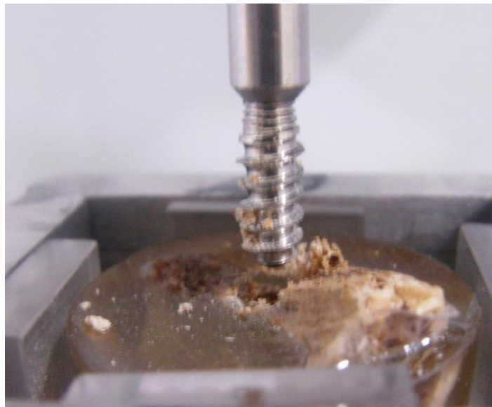
Figura 50 extracción del implante ensayo de Pull Out
