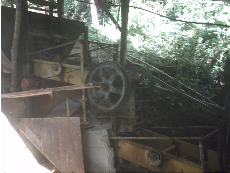
Figura 25. Tolva y trituradora primaria.
