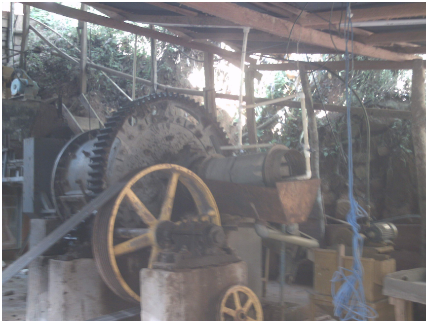
Figura 30. Planta de beneficio con su sistema de dosificación de agua.
