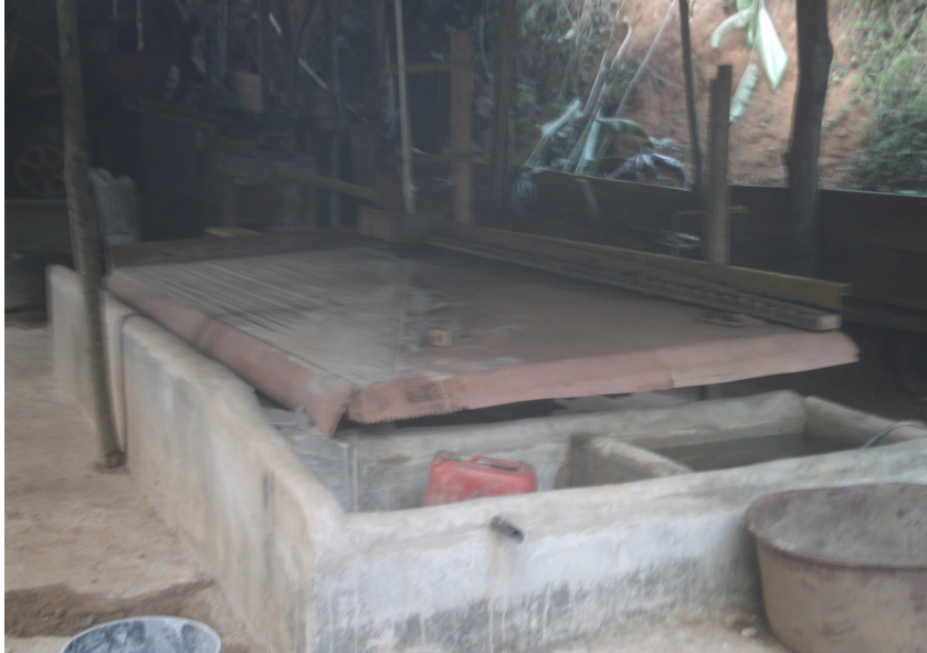
Figura 29. Mesa Concentradora Tipo Wifley
