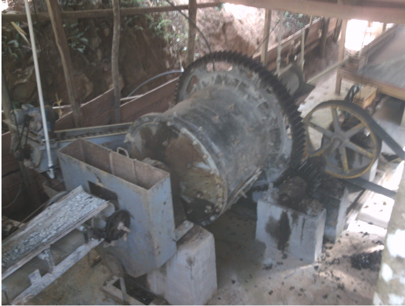
Figura 27. Molino de bolas.
