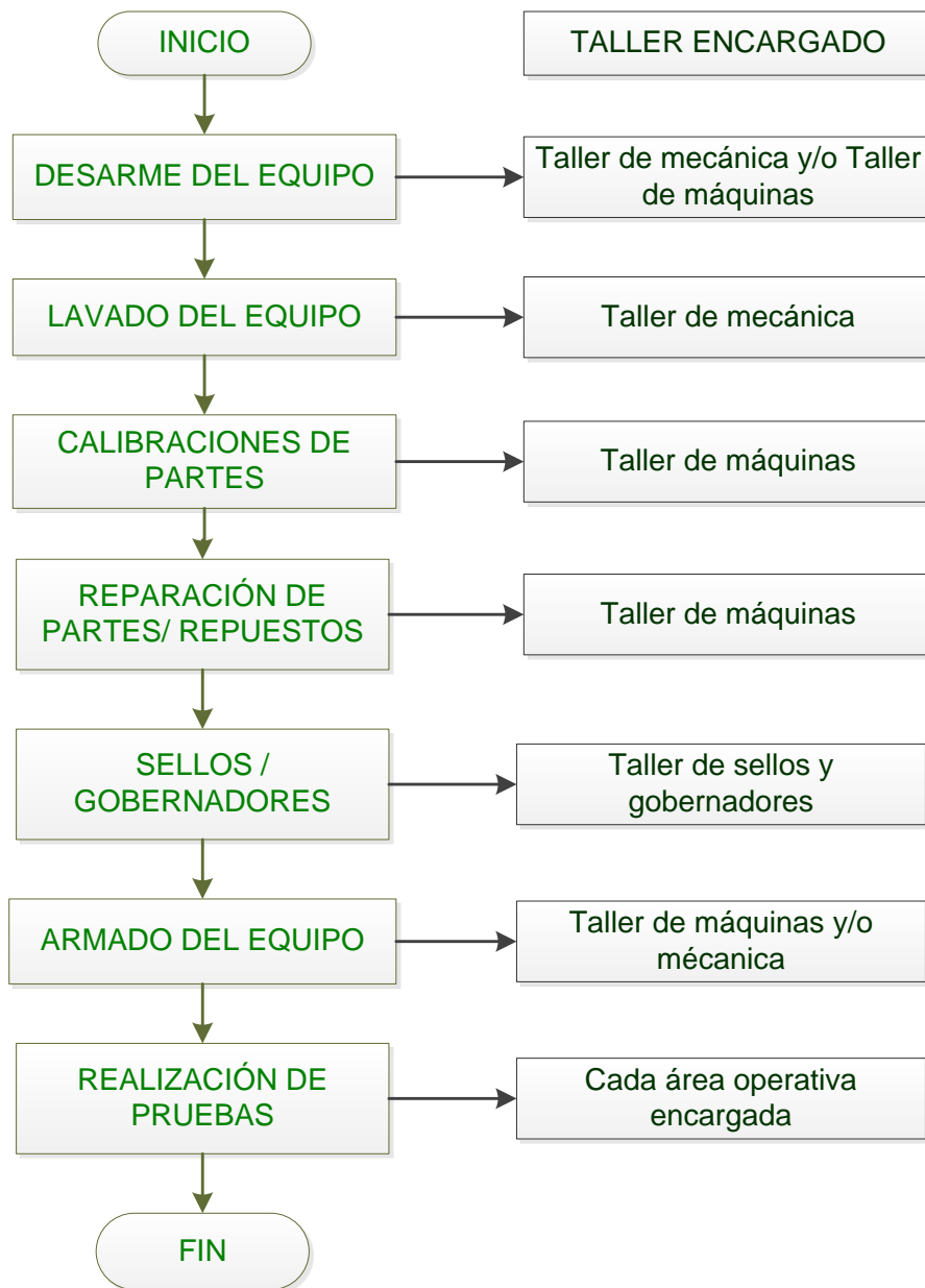
Figura 25. Diagrama de flujo de procesos de reparación de equipos rotativos.
