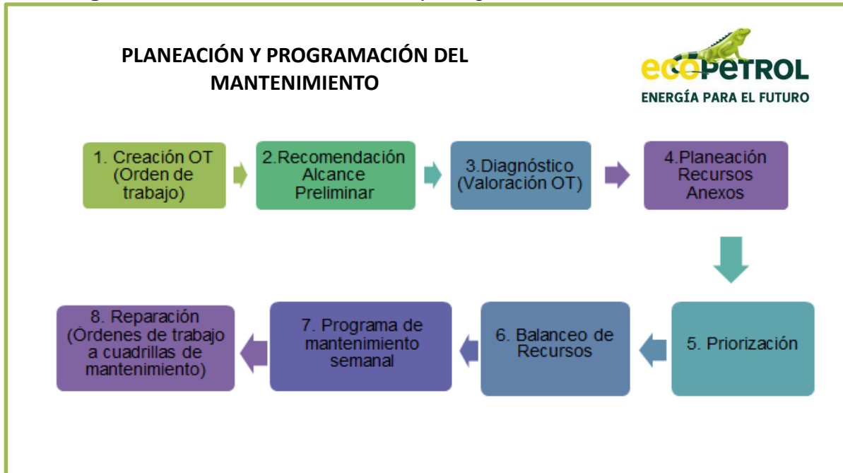
Figura 24. Proceso de Planeación y Programación del Mantenimiento.
