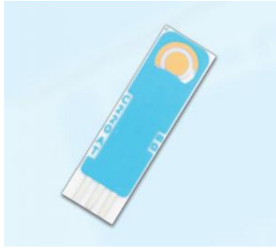
Figura 16. Electrodo de Oro serigrafiado utilizados en la toma de datos [65].
