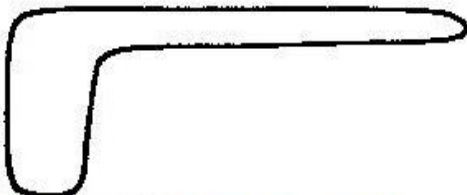
Condición pumping off - Tubería anclada.
