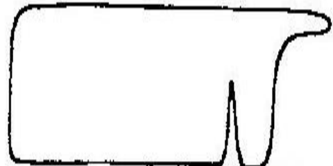
Golpe de fluido y reflexión de onda de las barras de peso.
