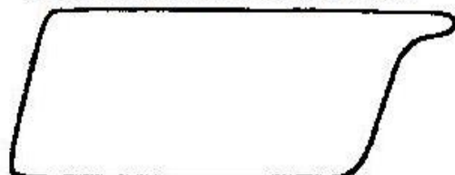
Golpe de fluido moderado - Tubería sin anclar.
