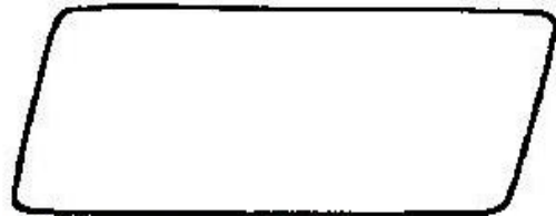
Bomba llena - Tubería desanclada ó ancla suelta
