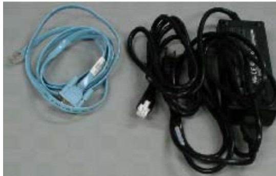
Figura 5. Cable de consola y cable de energía para el enrutador cisco 1700
