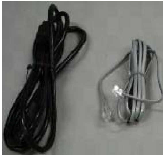
Figura 8. Cable de energía y cable (par dedicado de cobre) para la comunicación entre MODEMS.
