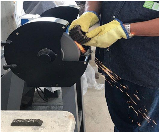
Figura 2. Prueba de chispa a un acero
