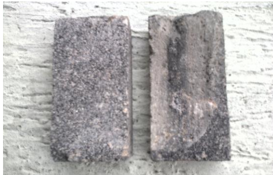
Figura 6. Briqueta con tratamiento térmico antes y después de la prueba de desgaste.
