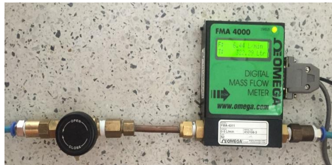
Figura 93. Equipos de monitoreo y medición de CO 2
