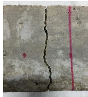
Figura 41d. Rotura por tracción indirecta de concreto reforzado con fibra
