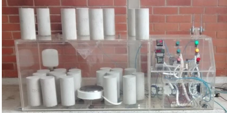
Figura 92. Cámara de carbonatación acelerada
