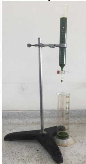
Figura 2. Ensayo de formación de espuma
