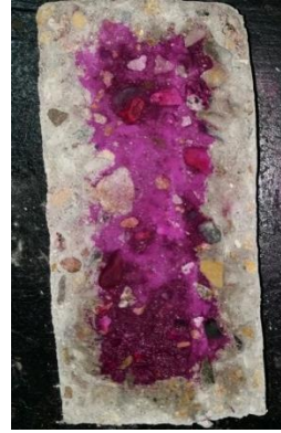
Figura 98b. Muestra de CS después de 144 horas de exposición a CO 2 .
