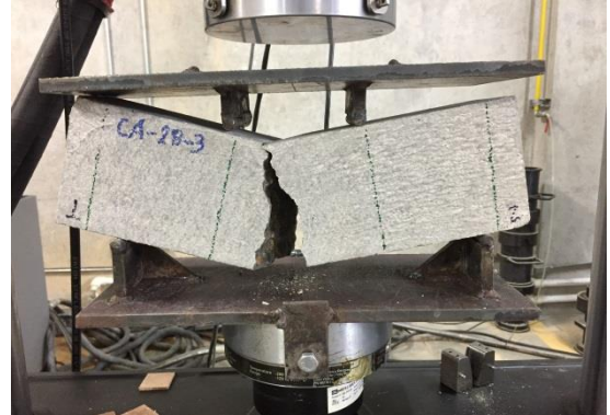
Figura 41. Fractura de concreto reforzado sin y con fibra de fique
