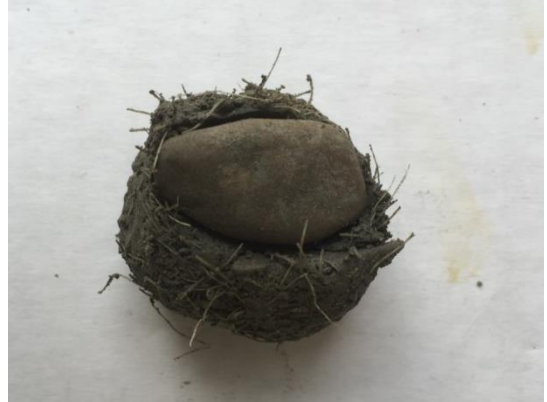
Figura 33. Concreto con fibra de fique en estado fresco
