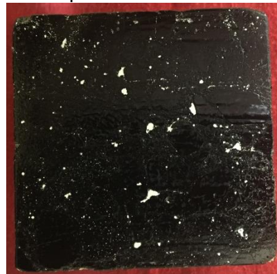
Figura 49d. Mezcla de concreto con 1,0% de fibra de fique
