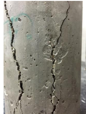
Figura 41b. Rotura por flexión de concreto simple
