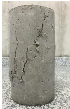
Figura 41a. Rotura por compresión de concreto simple
