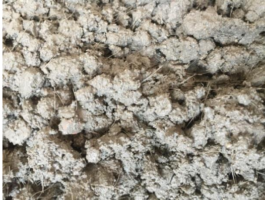
Figura 33. Concreto con fibra de fique en estado fresco
