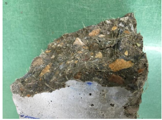
Figura 42. Superficie fracturada por rotura a flexo-tracción
