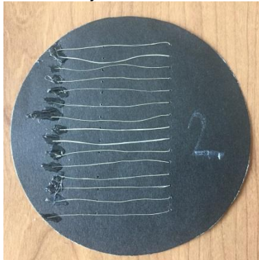
Figura 4. Montaje de muestras de fibra para observación en MOP y MEB
