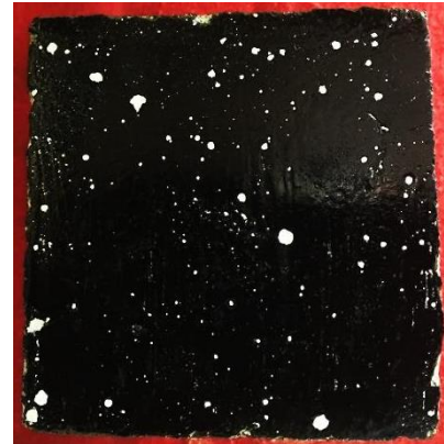
Figura 61b. Mezcla de concreto con 1,0% de jugo de fique
