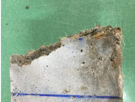
Figura 42. Superficie fracturada por rotura a flexo-tracción
