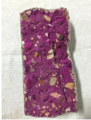
Figura 98a. Muestra de CS antes de ser sometida a carbonatación
