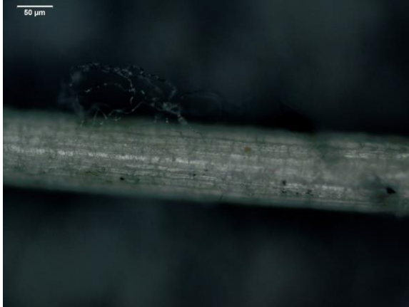
Figura 23. Microscopia óptica de fibra sin y con tratamiento en NaOH
