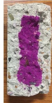
Figura 98d. Muestra de CJ2 después de 144 horas de exposición a CO 2 .
