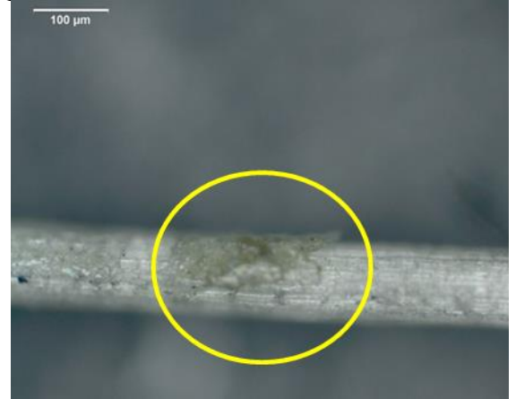
Figura 15. Microscopía óptica del aspecto longitudinal de la fibra de fique
