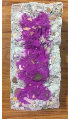
Figura 98c. Muestra de CJ1 después de 144 horas de exposición a CO 2 .
