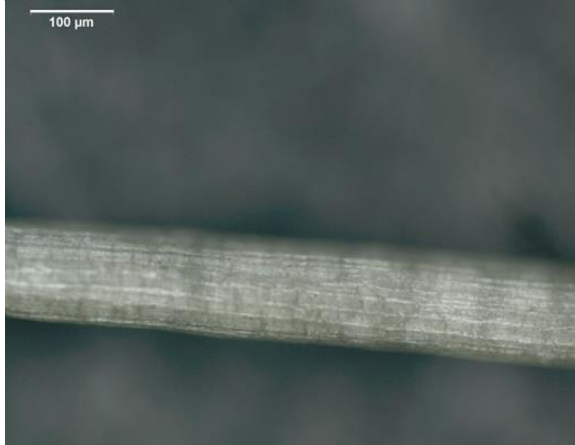
Figura 15. Microscopía óptica del aspecto longitudinal de la fibra de fique
