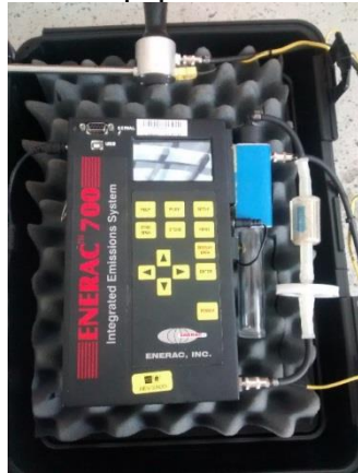
Figura 93a. Sistema de emisiones ENERAC 700
