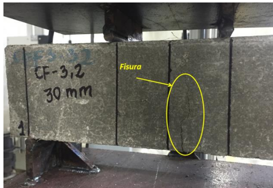
Figura 41c. Rotura por compresión de concreto reforzado con fibra
