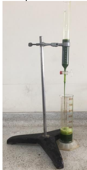
Figura 2. Ensayo de formación de espuma
