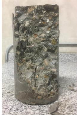
Figura 41. Fractura de concreto reforzado sin y con fibra de fique
