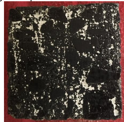
Figura 61d. Mezcla de concreto con 3,0% de jugo de fique
