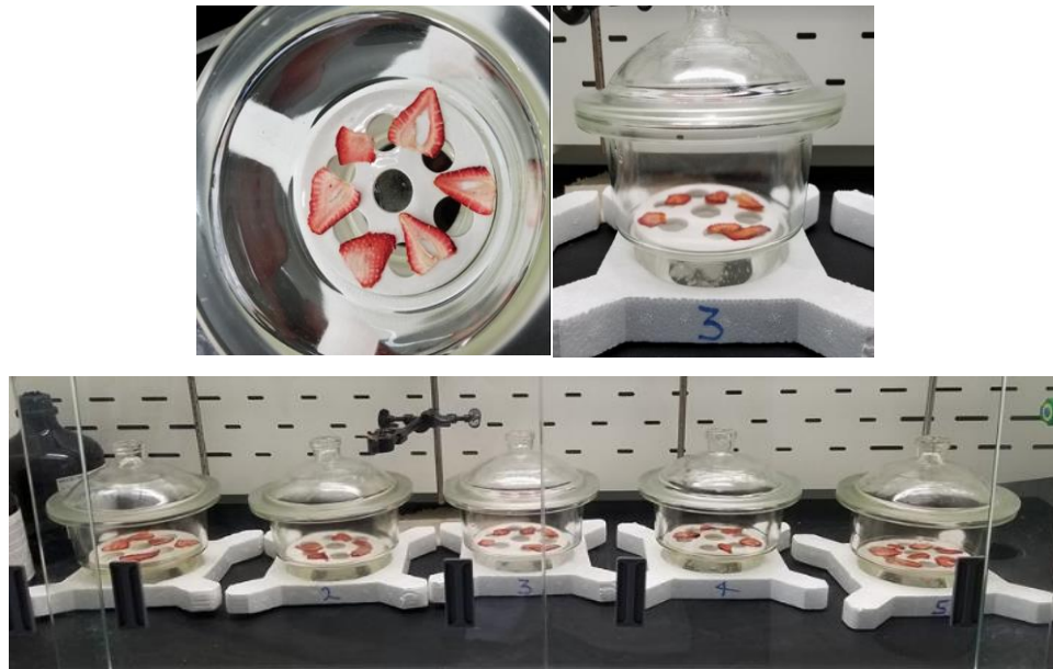
Figura 4. Montaje de cámaras de humedad
