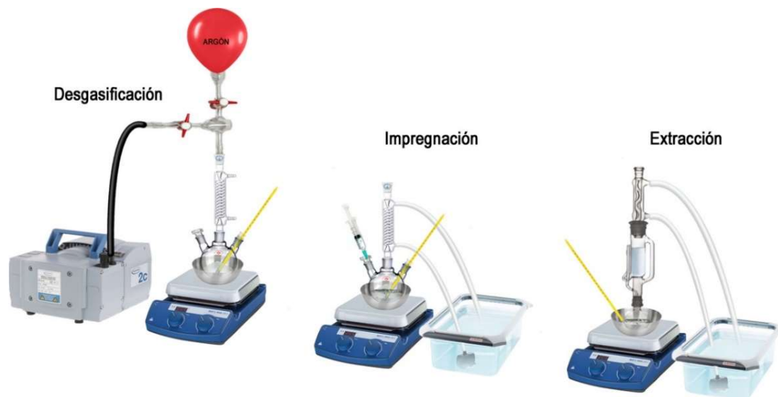
Figura 5. Montaje empleado en el proceso de impregnación del IL en la zeolita
