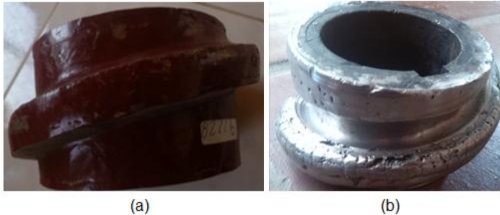
Figura 4. Fotografía de los tornillos tipo sin fin en cada uno de sus estados. (a) Tornillo tipo sin fin nuevo. (b) Tornillo tipo sin fin deteriorado.
